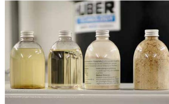
Von links: Grauwasser, gereinigtes Grauwasser, Probe Magnesium-Ammonium-Phosphat (auf dem Etikett steht: „Zur Düngung von Koniferen“), Filterkuchen aus der MAP-Fällung
