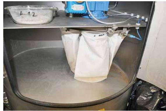
Blick in den MAP-Reaktor mit den Filtersäcken zur Phosphor-Rückgewinnung aus dem Urin
