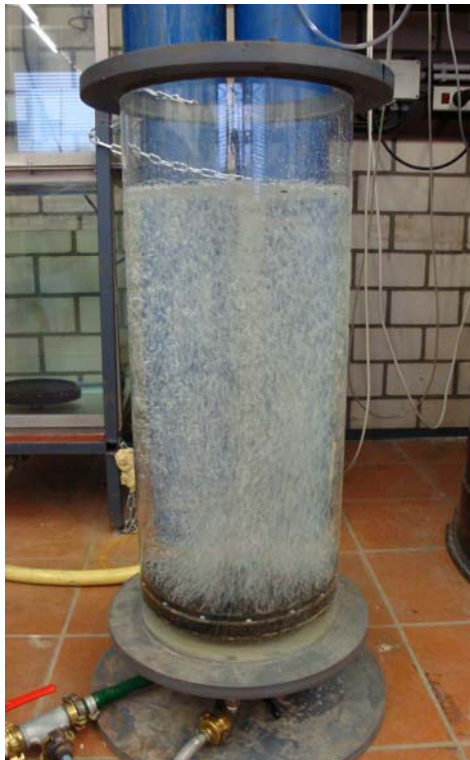
Abbildung 5-2: Versuchsanlage und Versuchsaufbau Druckluftbelüftung (VA DB 2)
