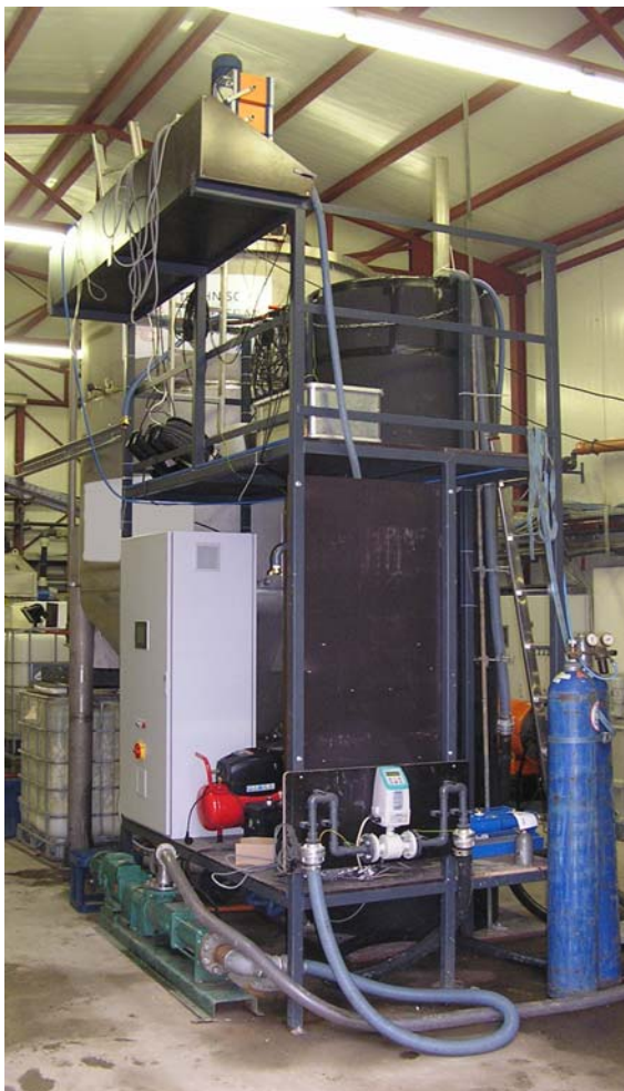
Abbildung 5-5: Fotos der Versuchsanlage (links: Versuchsanlage gesamt, rechts: Versuchssäule mit Druckluftbelüftung und Injektorbelüftung, Reinwasser und Belebtschlamm)
