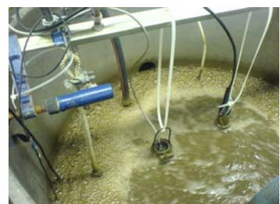
Abbildung 5-5: Fotos der Versuchsanlage (links: Versuchsanlage gesamt, rechts: Versuchssäule mit Druckluftbelüftung und Injektorbelüftung, Reinwasser und Belebtschlamm)
