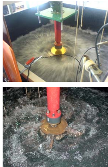
Abbildung 5-3: Versuchsanlage Kreislaufbelüfter (VA KB), Reinwasser und Belebtschlamm, links schematisch, rechts in Betrieb
