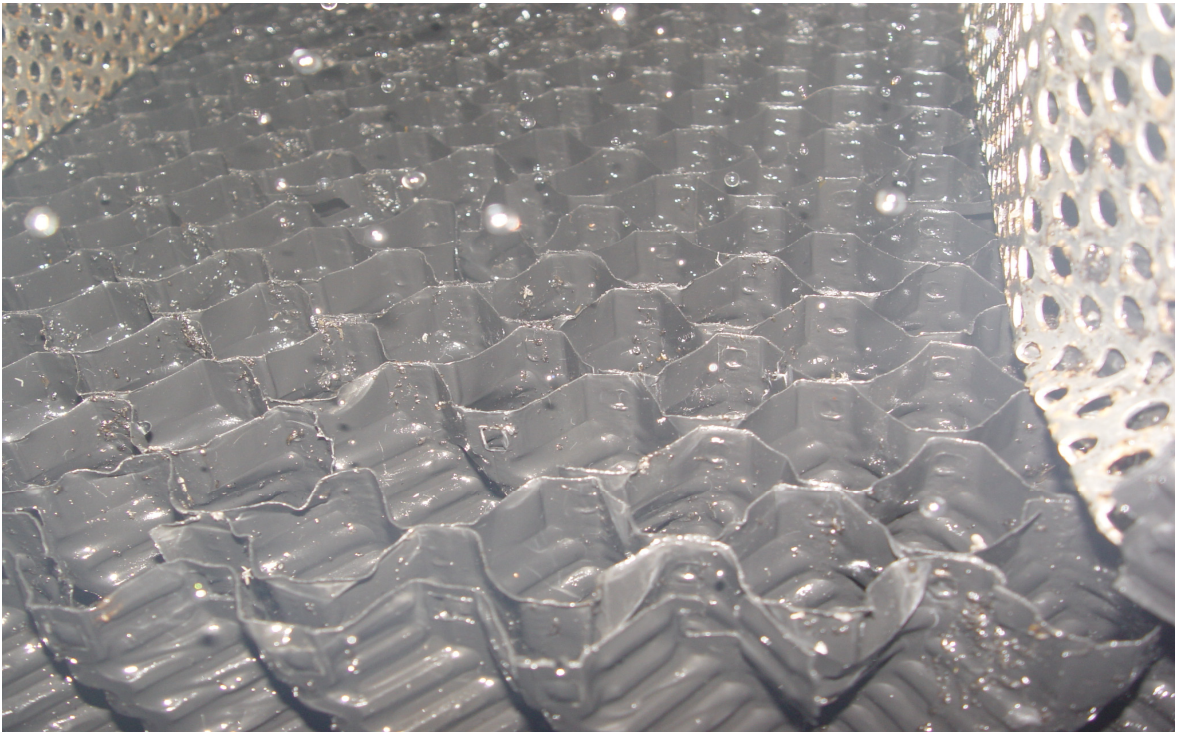
Abbildung 7.35: Kunststofffüllmaterial im mittleren Tropfkörperbereich (ca. 0,75 m über dem Gitterboden) des halbtechnischen Tropfkörpers bei ca. 0,21 kg BSB 5 /(m 3 ·d) am 04.06.2007
