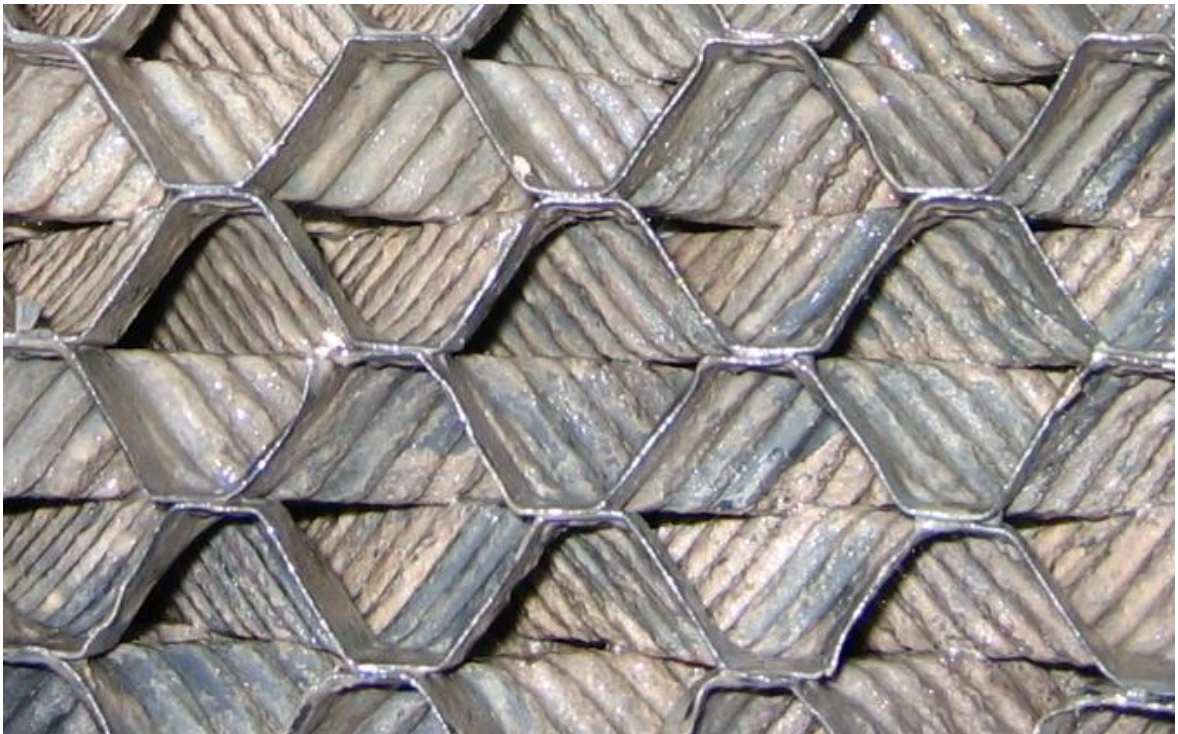
Abbildung 7.36: Biofilm im oberen Bereich des halbtechnischen Tropfkörpers mit Kunststofffüllmaterial bei ca. 0,98 \text{ kg BSB}_5/(\text{m}^3 \cdot \text{d}) am 16.11.2006
