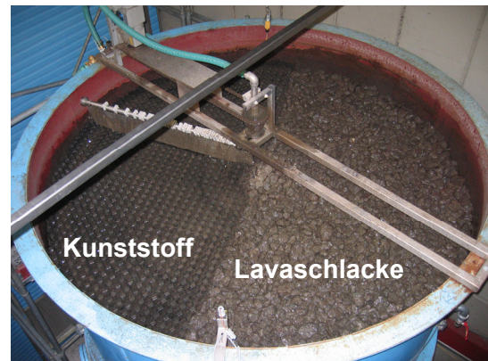
b) Draufsicht des Tropfkörpers
