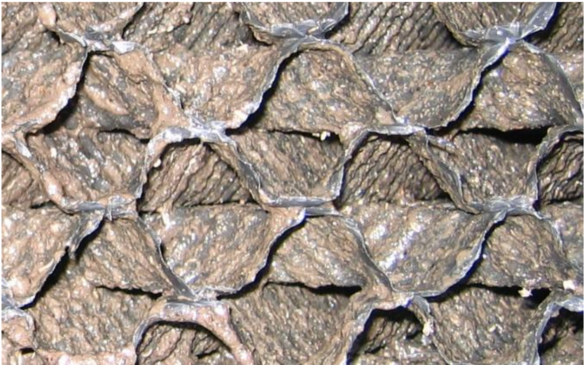
Abbildung 7.33: Biofilm in der Füllmaterialprobe (1 m über dem Gitterrost) des halbtechnischen Tropfkörpers mit Kunststofffüllmaterial bei ca. 0,98 \text{ kg BSB}_5/(\text{m}^3 \cdot \text{d}) am 16.11.2006
