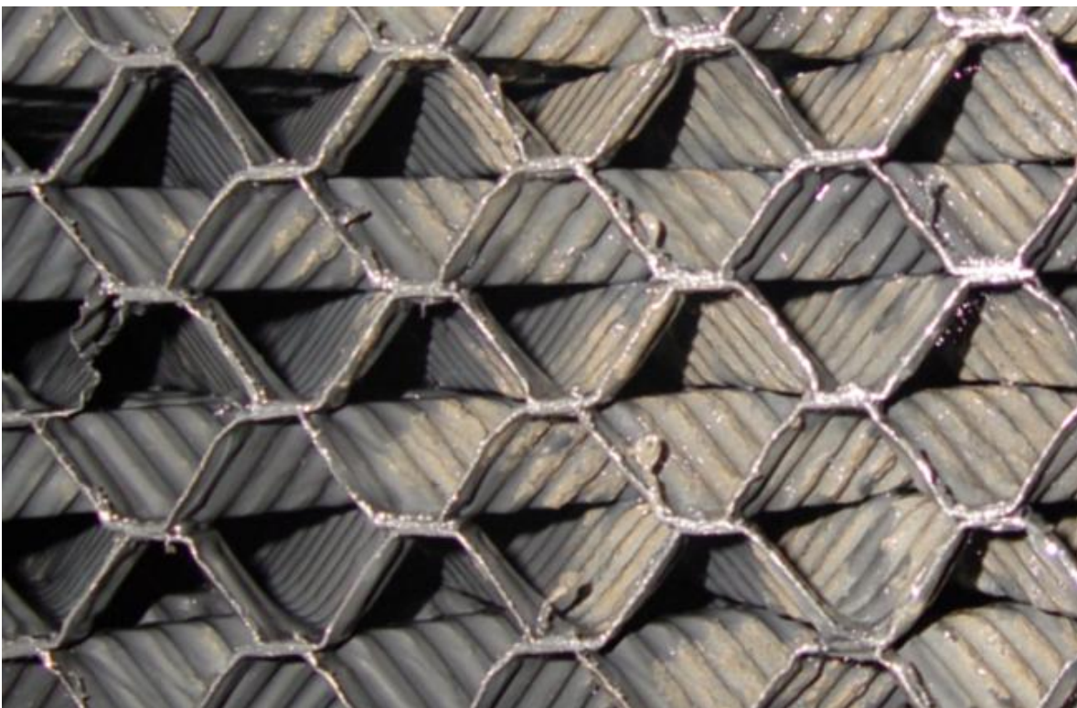
Abbildung 7.37: Biofilm im oberen Bereich des halbtechnischen Tropfkörpers mit Kunststofffüllmaterial bei ca. 0,21 \text{ kg BSB}_5/(\text{m}^3 \cdot \text{d}) am 04.06.2007
