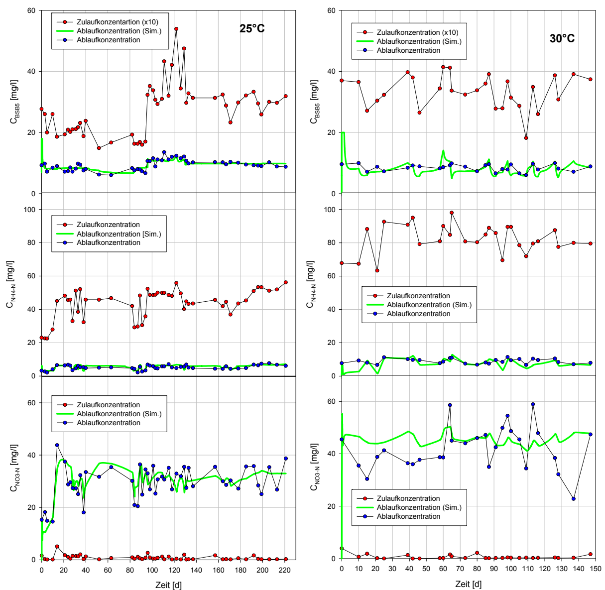
Abbildung 10.1: Vergleich der Simulationsergebnisse mit den Messergebnissen des kontinuierlichen Betriebs (nach Dutta, 2008)
