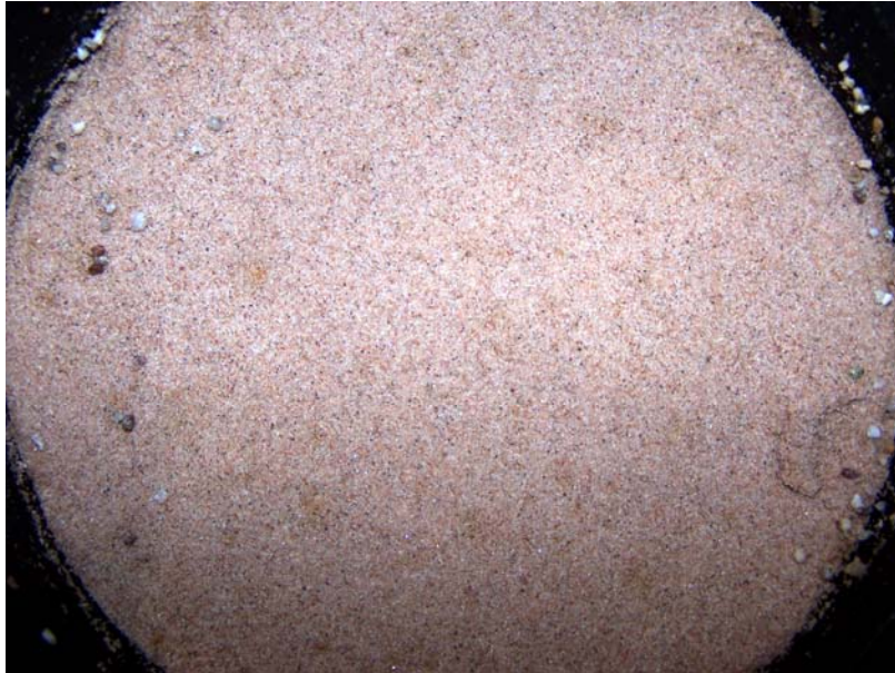
Abbildung 11.7: Langsamsandfilteroberfläche nach einer Betriebszeit von 2 Monaten
