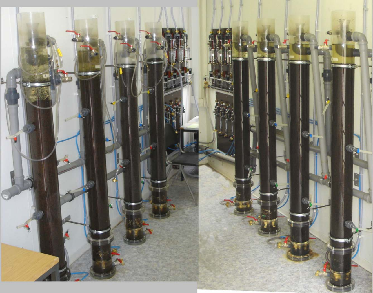
Abbildung 8 Einsicht der Versuchsanlage – Biofiltersäulen in Betrieb
