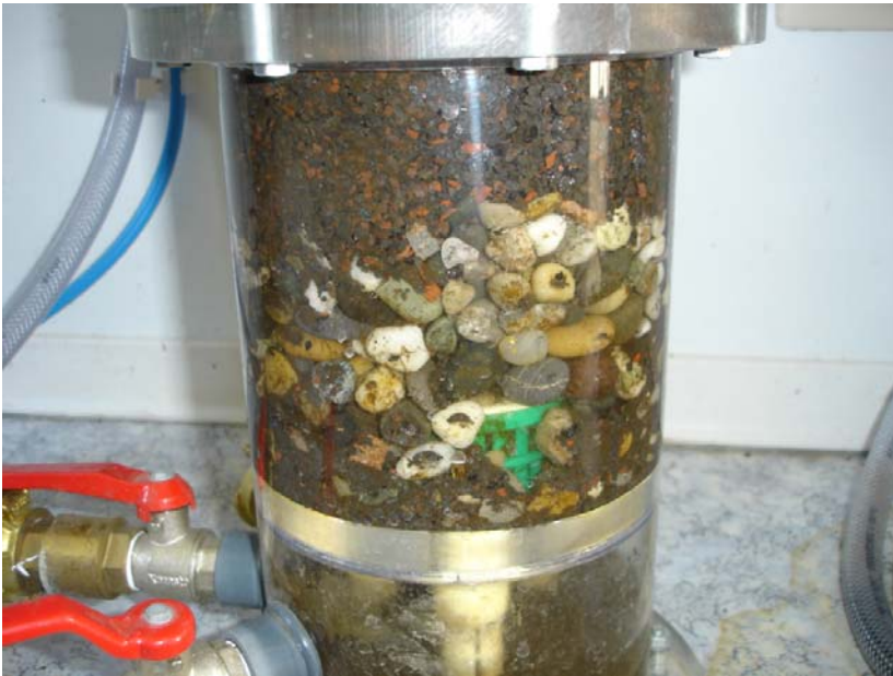
Filterboden einer Säule - Lagerung unter aeroben Bedingungen
