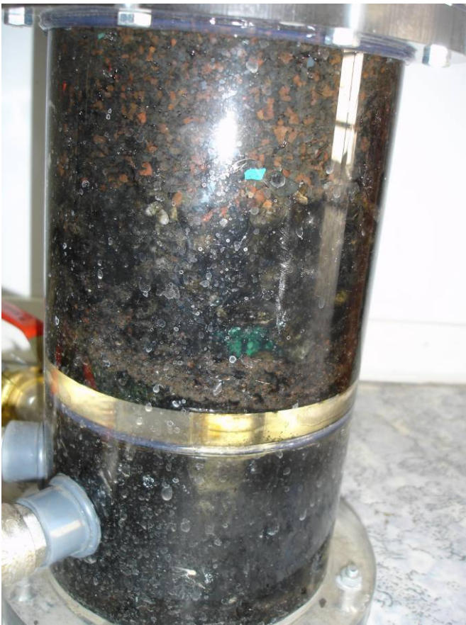
Filterboden einer Säule - Lagerung unter anaeroben Bedingungen
