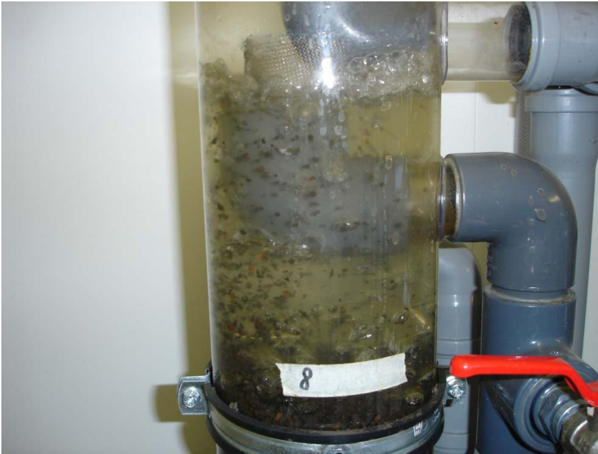
Biofiltersäule: Kopf (Filtratüberstand und Abläufe)
