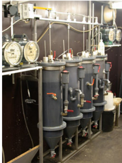
Bild 5: Versuchsreaktoren zur Klärschlammfäulung in der Klimakammer
