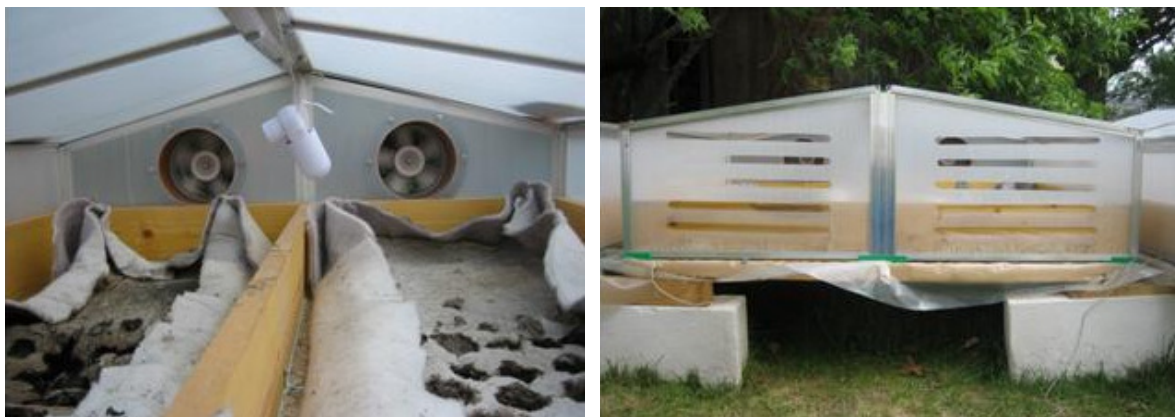
Bild 10: Versuchsaufbauten zur solaren Klärschlamm-trocknung mit Ventilation (Außenversuche)
