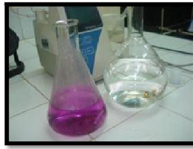
**Photo 2.** Titration de l'ammoniac dans la solution d'acide dorique par la solution d'acide chlorhydrique (1N)
