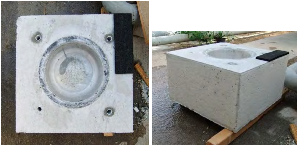
Abb. 6.1: Modell eines möglichen Niedertemperatur-HTC-Reaktors
