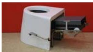
Avec les toilettes sèches d'ECODOMEO, la séparation de l'urine des excréments n'est pas réalisée à l'aide d'un pot de dérivation, mais plutôt à l'aide d'une bande convoyeuse située à l'intérieur du siège de toilette. L'urine coule en dessous de la bande sur une espèce d'entonnoir qui
