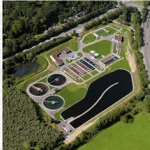
Konventionelle Kläranlage mit biologischer Reinigung
