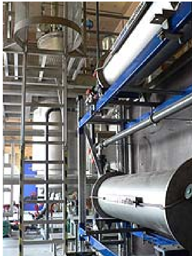
Bild 5: Membranbioreaktor zur anaerob psychrophilen Abwasserreinigung
