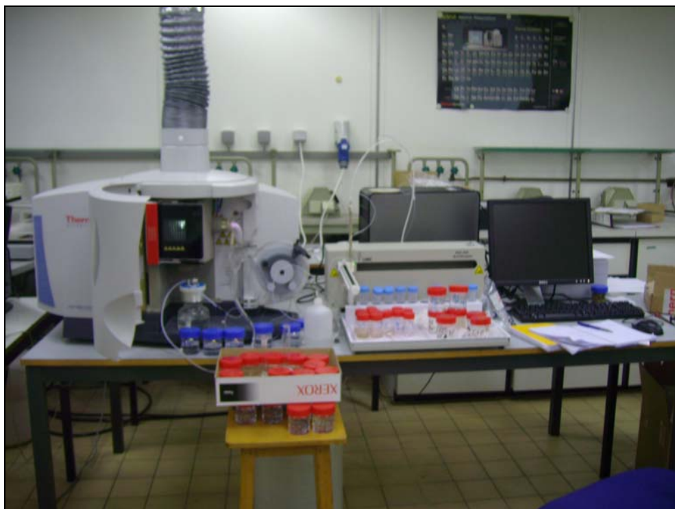
Figure 15 : Mesure des éléments majeurs et éléments traces métalliques par attaque totale
