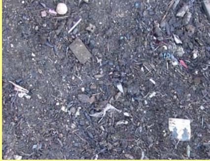
Photo A . Tas de compost final présentant une proportion importante de divers corps étrangers : morceaux de carrelage, petits objets en plastiques, os, ampoules, bois, etc
