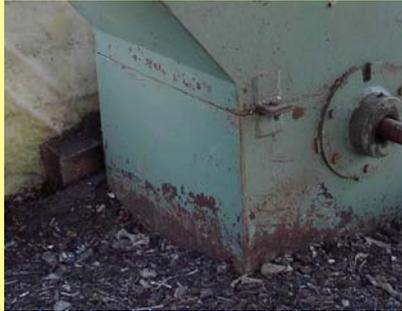
Photo B . Etat de broyeur après une année de fonctionnement. Cela peut être attribué aux effets combinés de la nature des matériaux, à l'humidité des déchets et au manque d'entretien
