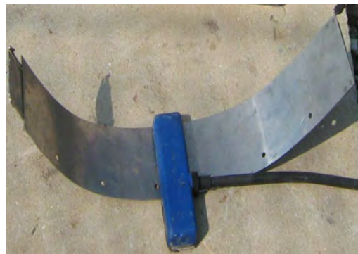
figure 44 : Sonde du débitmètre
