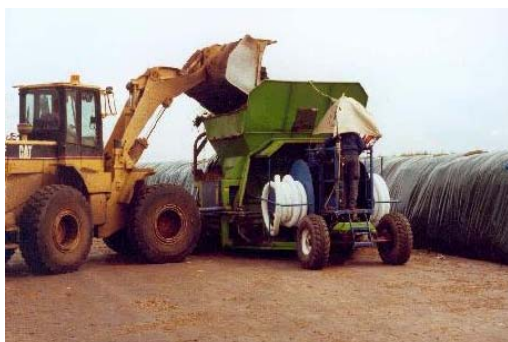
Abb. 31: Beladevorgang eines Folienschlauches Folienschlauchverfahren zur Feststofffermentation
