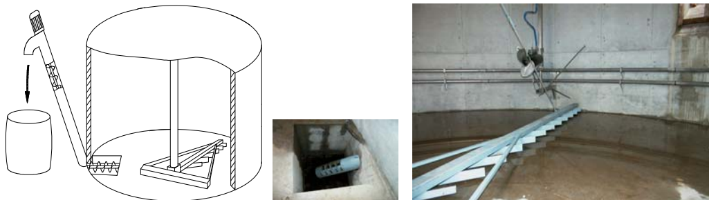
Abb. 43: Bodenräumer zum Austrag von Schwerstoffen (Mitte: Austragsschnecke)
