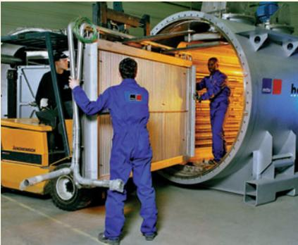
Abb. 1: Montage einer „Hot-Modul“-Brennstoffzelle
