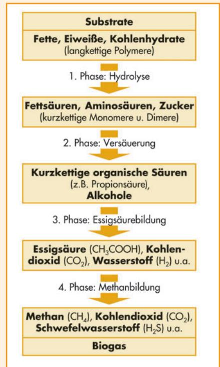
Abb. 2: Vereinfachte Darstellung des Abbaus organischer Substanz bei der Biogasgewinnung
