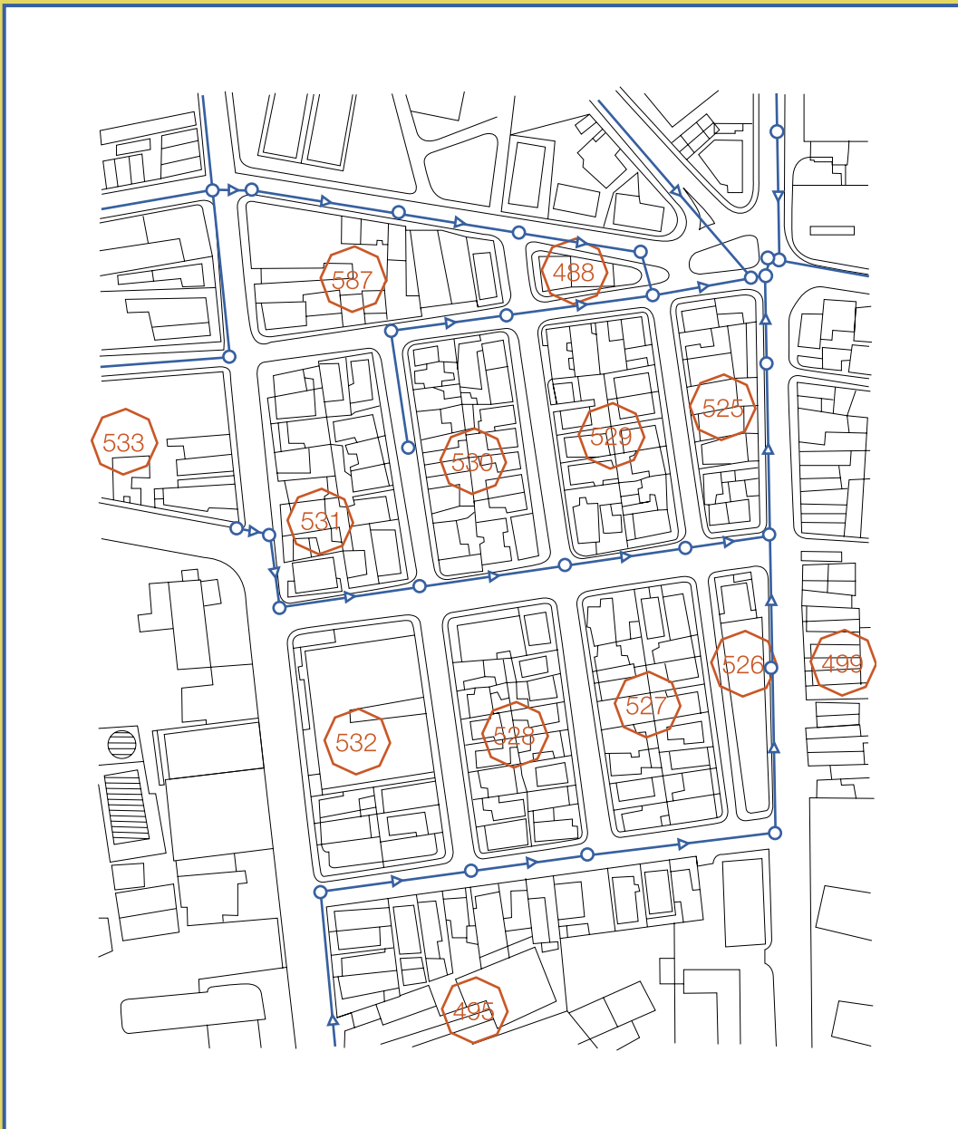
Figura III.3: Diseño de la red pública para Bacio do Alto Camarujipe
