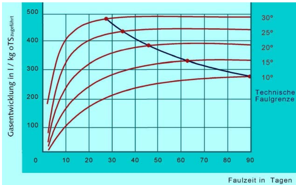
Abbildung 20 Gasentwicklung in Abhängigkeit der Faulzeit und Temperatur im Faulturm
