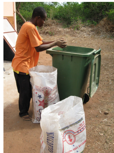
Abb. 14 Die 240l-fahrbaren Sammelbehälter werden mit einer Schicht Sägespäne als Drainage befüllt.
