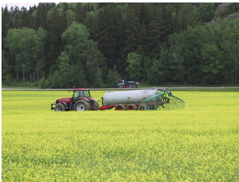
Figure 4 : Urine humaine répandue sur les champs à l'aide d'équipement mécanisé en suède (Photo : Werner.C, 2006)
