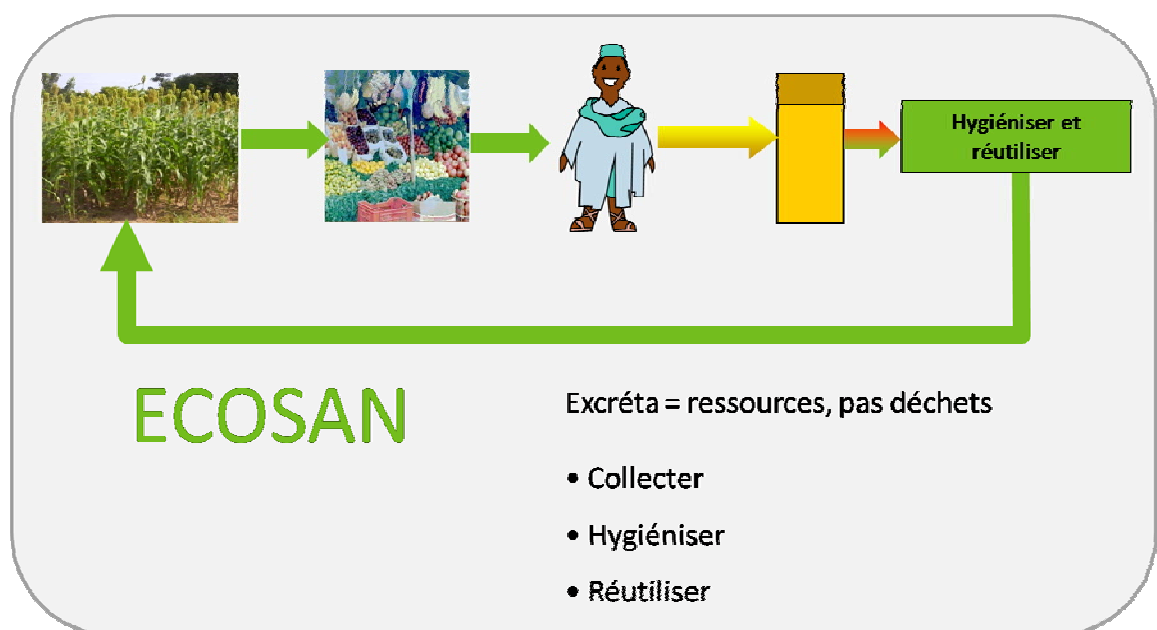
Figure 3 : Ecosan, système d'assainissement des excréments humains qui vise à valoriser nos urines et nos fèces (Werner, 2008)
