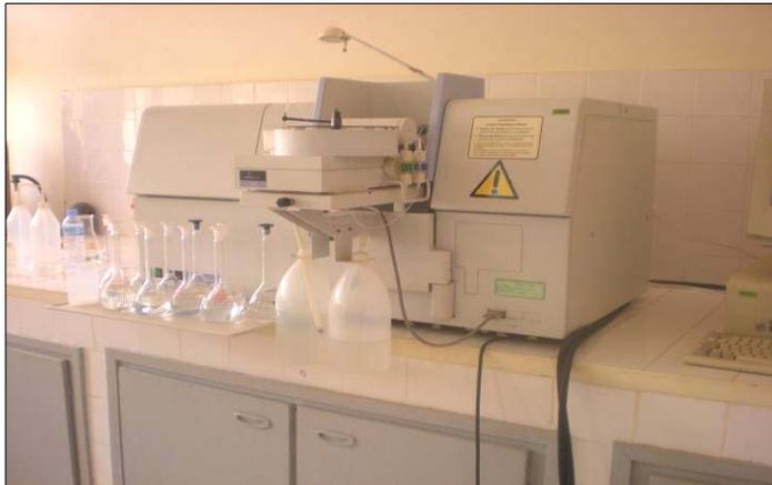
Photo 13. Spectromètre d'absorption atomique et des accessoires
