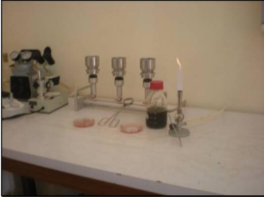
Photo 9. Rampe de filtration sur membrane et milieu de culture en boîte de pétri
