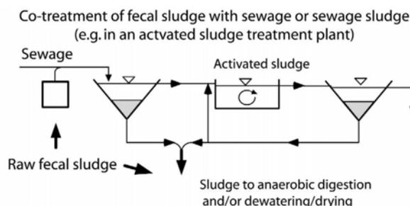
Quand utiliser ce système? La seule condition est l'existence d'une station d'épuration en place ou en projet. La STEP doit avoir des capacités suffisantes pour l'accueil supplémentaire des boues de vidange.
