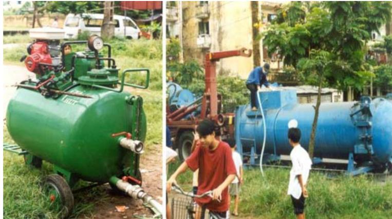
Figure 14: Petite cuve à boues reliée à une pompe manuelle d'aspiration à Mapet, Congo
