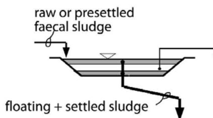
**Quand utiliser ce système?** Les étangs de sédimentation/stabilisation peuvent servir au traitement primaire des BV lorsque la station dispose de suffisamment d'espace. Ce type de dispositif convient aux BV fraîches et constitue souvent la première cellule d'un système de lagunage composé d'une série de bassins de stabilisation.
