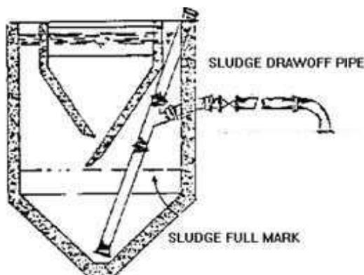
Quand utiliser ce système? Le décanteur-digester peut être utilisé pour la décantation et la digestion simultanée des BV insuffisamment stabilisées. Il peut être utilisé quand les conditions ne sont pas favorables au fonctionnement d'un digesteur avec production de biogaz et quand le site n'offre pas suffisamment d'espace pour des étangs de stabilisation.
