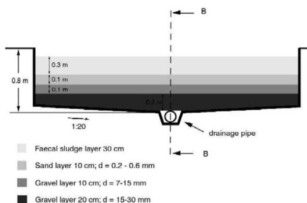
chargées sur le lit et l'eau qu'elles contiennent s'évacue dans sa majorité par percolation à travers le filtre, le reste par évaporation. Les boues ainsi déshydratées peuvent être soit directement mises en décharge soit soumises à un traitement d'hygiénisation si une valorisation agricole est envisagée. La qualité des percolats est améliorée par la filtration mais un polissage peut être encore nécessaire.
