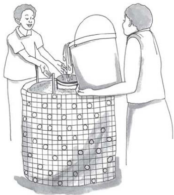
Abbildung 9: Prinzip der Grauwassertürme (Quelle: Crosby, 2005)
