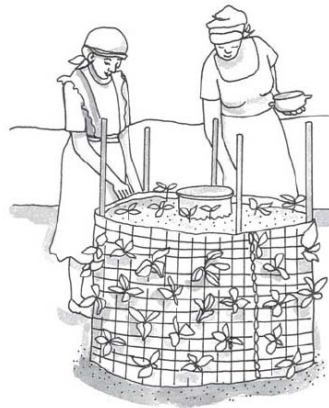
Abbildung 9: Prinzip der Grauwassertürme (Quelle: Crosby, 2005)
