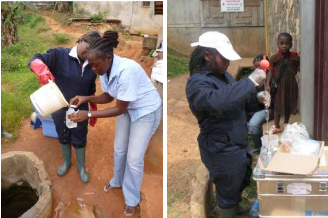
Figure 10: (A gauche) Au point d'eau, l'échantillon microbiologique était d'abord prélevé en utilisant l'équipement local disponible (Olezoa). A droite, utilisation d'une pipette pour déverser un échantillon d'eau prélevée dans une fiole à Ngoa-Ekellé - (left) After reaching the waterpoint, the microbiological sample was always taken first, making use of the local equipment present (Olezoa); (right) Pipetting a TIC/TOC-subsample into a glass vial at Ngoa-Ekellé.
