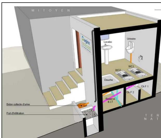
Figure 1: Le principe des chambres de déshydratation d'une TDSU: Vue en coupe. Les deux chambres de déshydratation sont appelées « Ch F1 » et « Ch F2 » ici (source: GIZ AGIRE, 2014).
