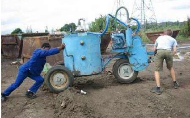
Figure 3: VacuTug en test dans une communauté de la municipalité Msunduzi en Afrique du Sud, avec toilettes à faible débit (source: WRC, 2012).
