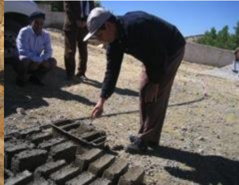
2 – production des briques en ciment
