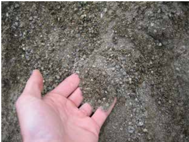
Image 689 : Sable propre (sans argile) mais avec taille du grain inhomogène. Cette qualité de sable est bonne pour faire du béton, mais pour faire des enduits il faut la tamiser.
