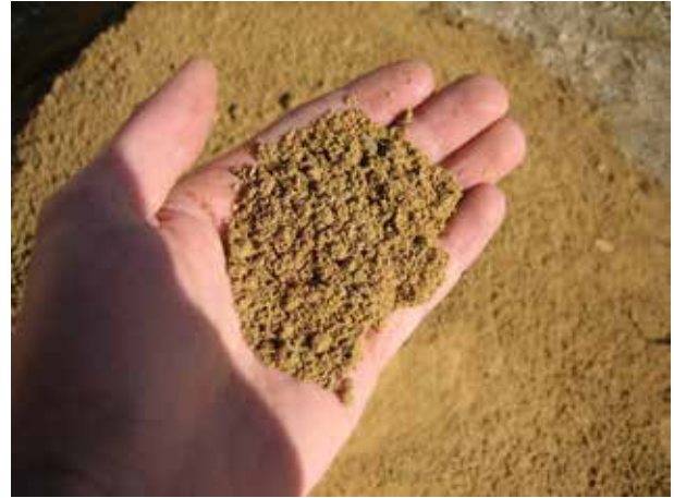
Image 688 : Sable de mauvaise qualité (haute teneur d'argile).
