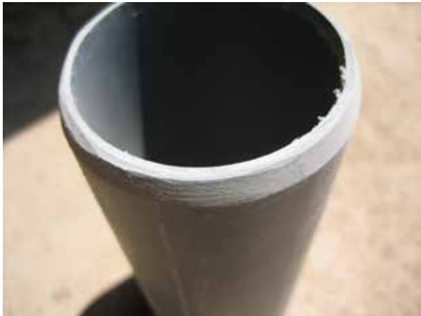
Image 84 : Tuyau PVC biseauté (pièce mâle, outil pour faire des manchons).
