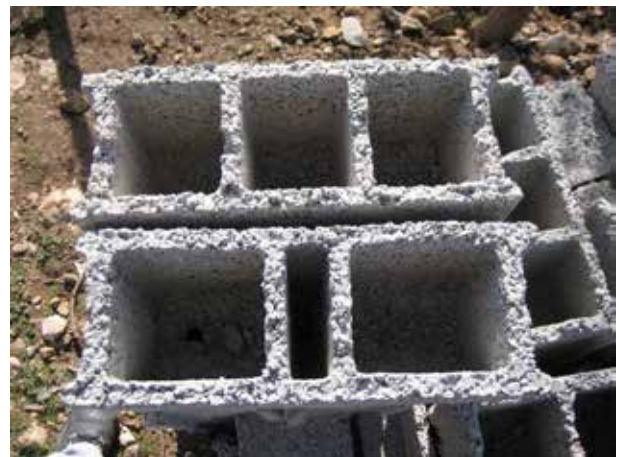
Image 700 : Briques (blocs) en béton 20 x 15 x 40 cm.
