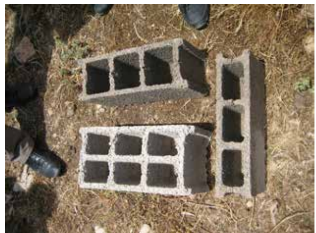
Image 702 : Trois sortes de briques (blocs) : 20 x 10 x 40 cm, 20 x 15 x 40 cm, et 20 x 20 x 40 cm.
