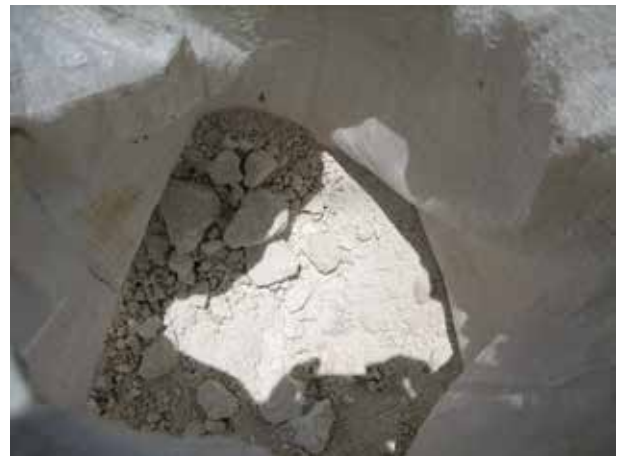
Image 696 : Chaux de mauvaise qualité.
