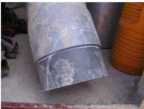
Image 88 : Le marquage montre la partie à découper pour une ventilation idéale.
