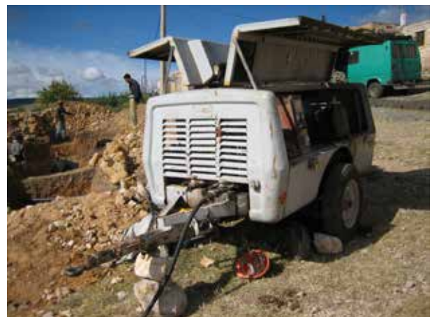
Image 378 : Compresseur pour le marteau pneumatique.
