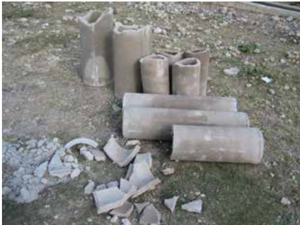
Image 697 : Buses en béton de mauvaise qualité (cassées durant le transport).
