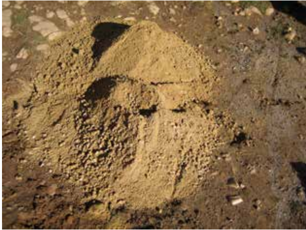
Image 687 : Sable de mauvaise qualité (haute teneur d'argile et taille du grain inhomogène).
