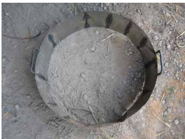
Image 469 : Moule du couvercle avec deux poignées.
