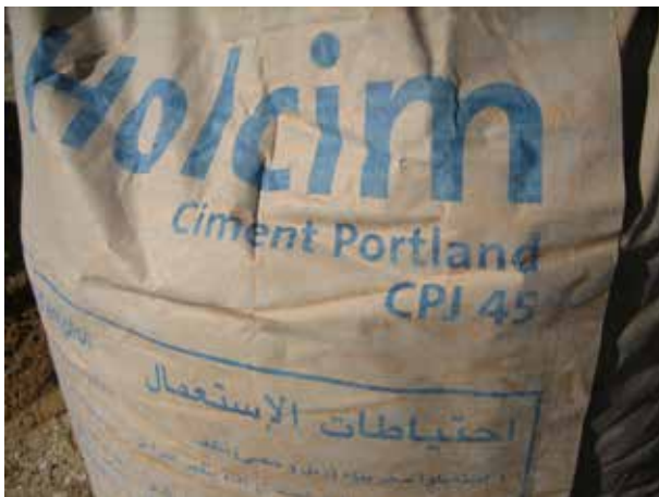
Image 699 : Ciment Portland CPJ 45. CPJ 45 sèche plus vite que CPJ35.
