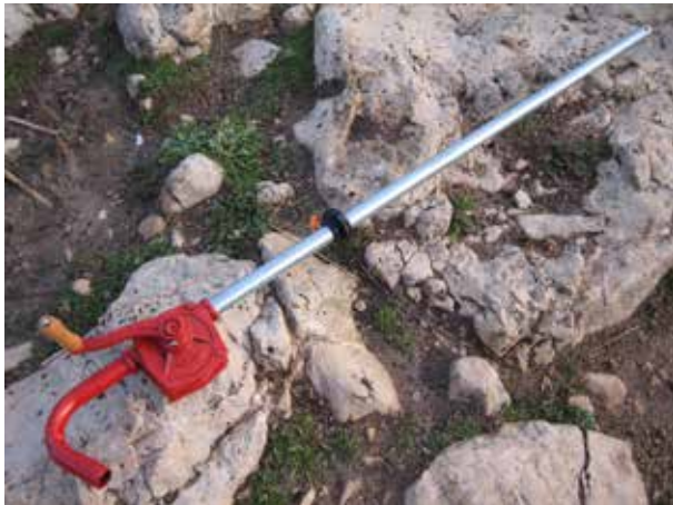
Image 709 : Pompe manuelle (pour vidanger le réservoir d'urine dans un bidon portable).
