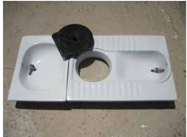
Image 710 : Siège de toilette à séparation d'urine (type indien de Shital Ceramics). Le compartiment à gauche est prévu pour les eaux de nettoyage anal. Dimensions : 895 x 425 mm (pièce nettoyage anale : 310 x 425 mm, pièce toilette : 585 x 425 mm). www.ruralsanitation.net
