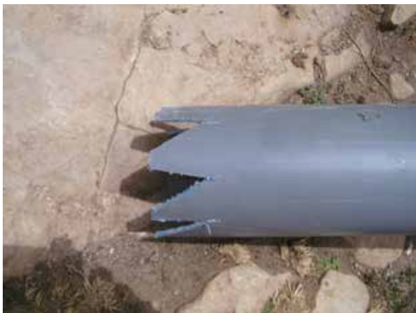
Image 98 : Tuyau plongeur pour le réservoir d'urine.
