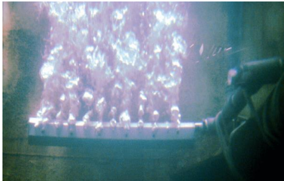
شكل ٩-٧ ناشر الفقاعات الخشنة من طراز (غذاية الدجاج)، وعلى اليمين النموذج معروض خارج المياه، بفتحات ذات حجمين وشق مفتوح. وفي اليسار صورة تحت سطح الماء لواحدة من هذه الناشرات أثناء التشغيل في مياه نظيفة. لاحظ الدوامات العالية المتولدة من الفقاعات الخشنة (photo: M.K. Stenstrom).
