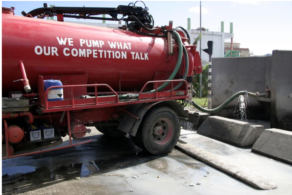
شكل ٣-٥ شاحنة تفرغ محتويات خزانات التحليل من المنازل في خزان بمحطة معالجة مياه صرف صحي طريق إيدج في سانت مارتن (صورة: D. Brdjanovic)
