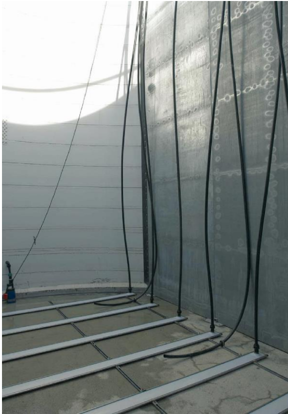
صورة ٩-٢٦ ناشرات ذات ثغوب دقيقة (في وضع شرائح من الأغشية) موضوعة في حوض بكامل عمقه (٥ أمتار في العمق) قبل اختبار مياه نظيفة (photo: M.K. Stenstrom)
