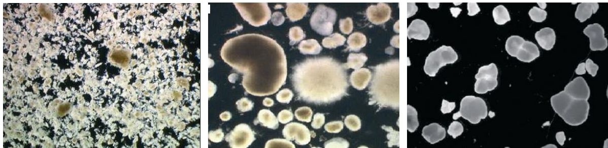
شكل ١٨-٨ تطور الحمأة الحبيبية الهوائية في مفاعل دفع هوائي ذي دفعات متتالية، تبدأ من الحمأة المنشطة التقليدية بعد ٤ (أ) و ١٣ (ب) و ٨٧ (ج) يومًا من تشغيل المفاعل (شريط القياس = ١ مم)
