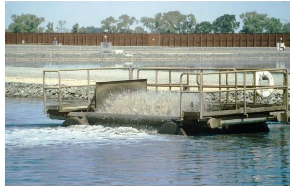
شكل ٩-٥ "هواية سطحية ذات فرشاة مركبة على برج عائِم في بحيرة تهوية" (photos: M.K. Stenstrom)
