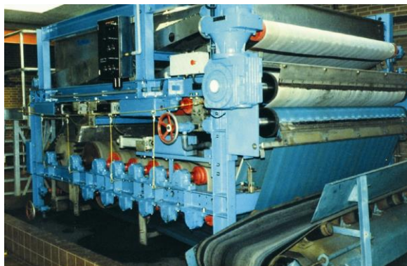
شكل ٣-٨ حزام مرشح لتجفيف الحمأة Belt Filter: يتم تجميع المياه الخارجة من أسفل المعدات الميكانيكية (صورة: D. Brdjanovic)
