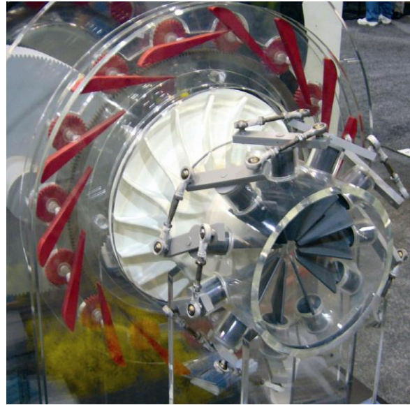
شكل ٩-١٤ نموذج ثلاثي الأبعاد لنافخ طارد مركزي ذو مرحلة واحدة ذات ريشات توجيه (الرمادية اللون) وريشات توزيع (الحمراء اللون) معروضة في معرض تجاري (photos: D. Rosso)
