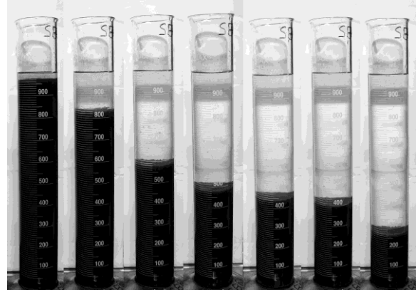
شكل ١٢-١٢ مدى التقدم في اختبار سرعة منطقة الترسيب عند ١، ٢، ٤، ٦، ٨، ١٠، ٤٥ دقيقة (photo: Environment Canada)
