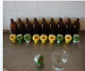
← جهاز قياس الـ BOD<sub>5</sub> بواسطة رؤوس الكترونية
