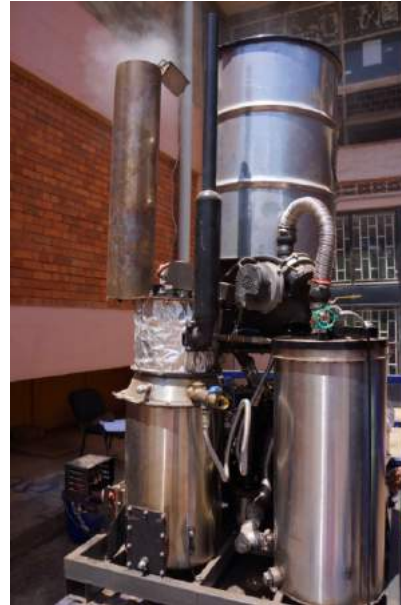
Gasifier, Kampala Pellets
