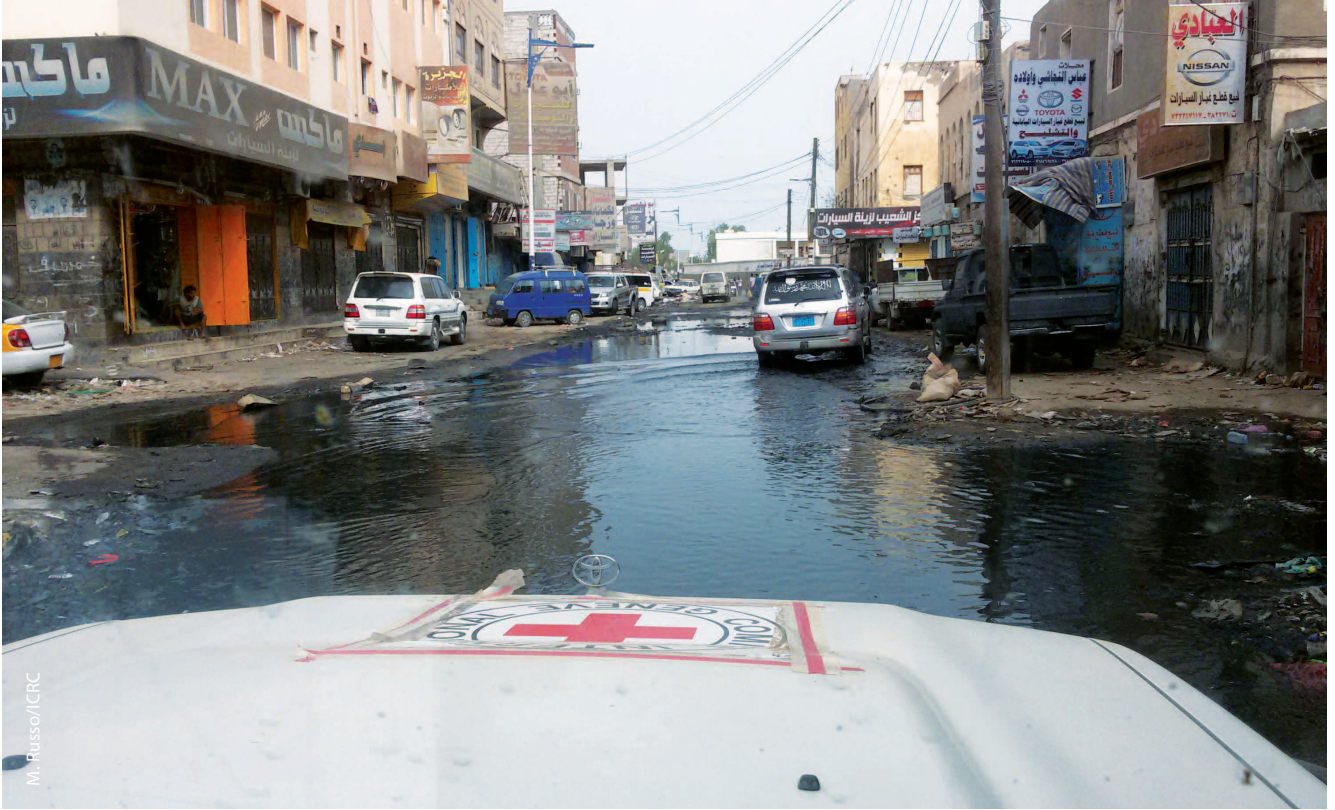
الصورة 6: الترابط بين حاجات الخدمات الأساسية ليتم فهمها ودمجها الصحيح في الاستجابة الطارئة لأي عطل من أجل تجنب المؤثرات ذات النتيجة العكسية. إصلاح شبكة الإمداد بالمياه المعطلة لهذا الحي دون معالجة شبكة تفريغ مياه الصرف الصحي المتضررة سيزيد من تعرض السكان لمخاطر الصحة العامة عن طريق التسبب بتدفق مياه الصرف الصحي إلى الشوارع. (عدن، 2015)
