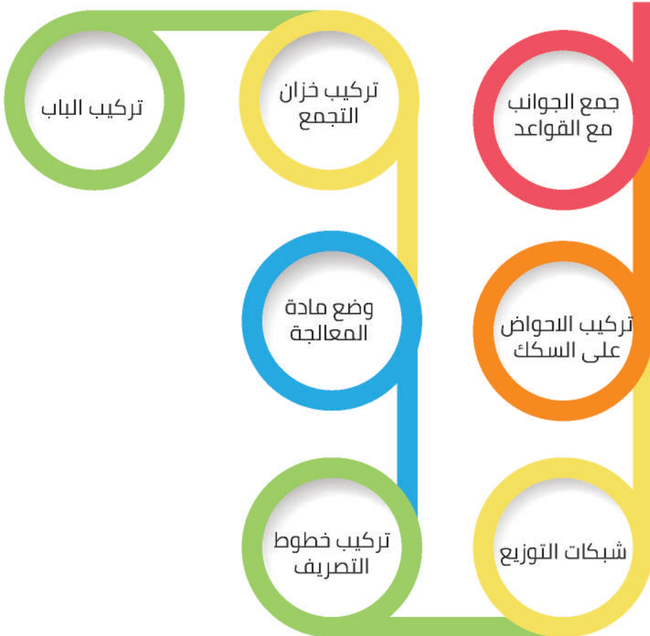
الشكل رقم (١٠): خطوات تركيب نظام الفلتر الرملي ذو الطبقات المتحركة
