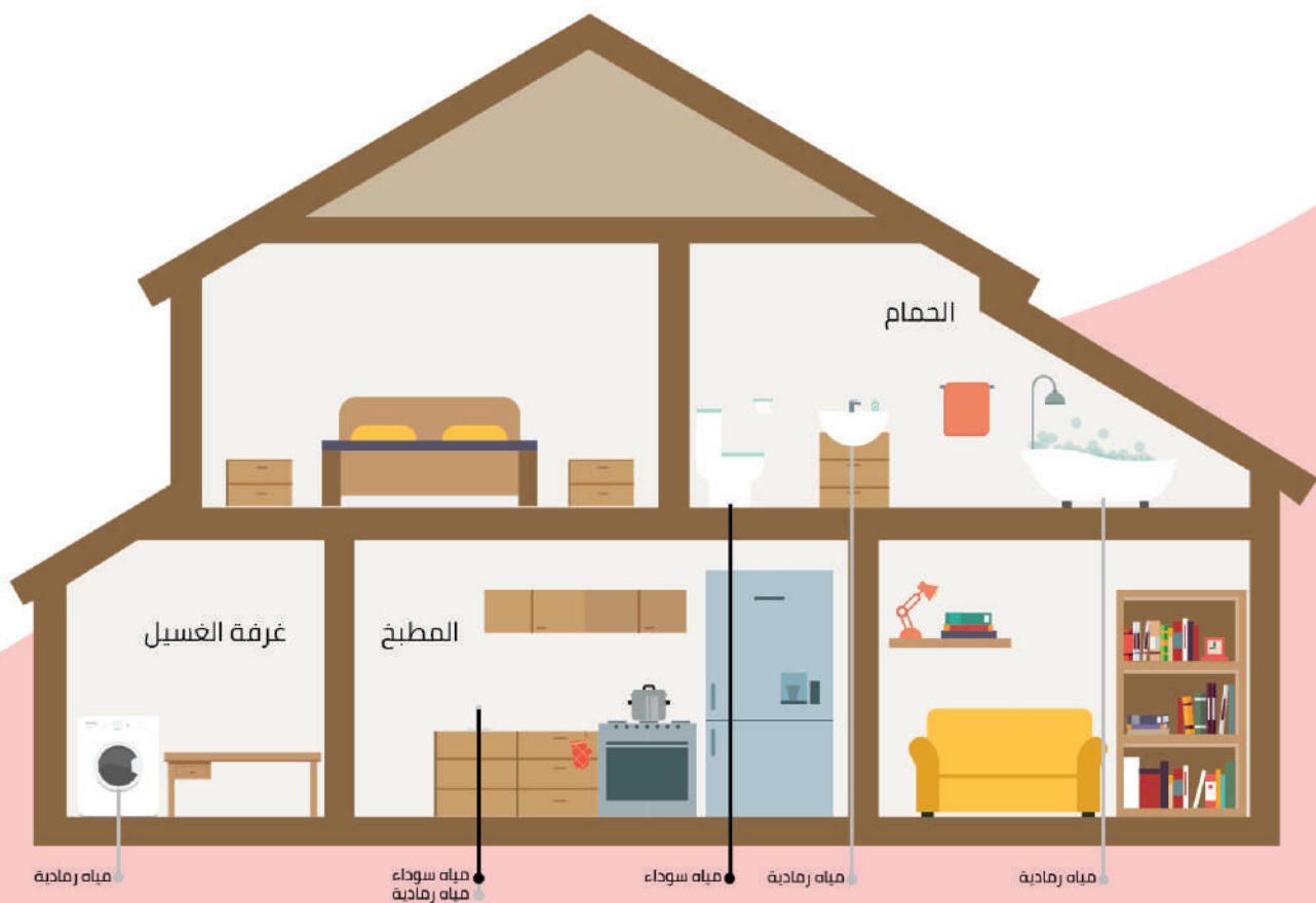
الشكل رقم (1): رسم توضيحي يبين كل من المياه السوداء والمياه الرمادية
