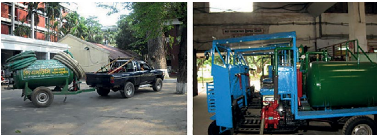
Figura 4.11 Los modelos Mark III (izq.) y Mark IV (der.) de BREVAC, aparatos para succionar y transportar lodos fecales (foto: Peter Edwards).
