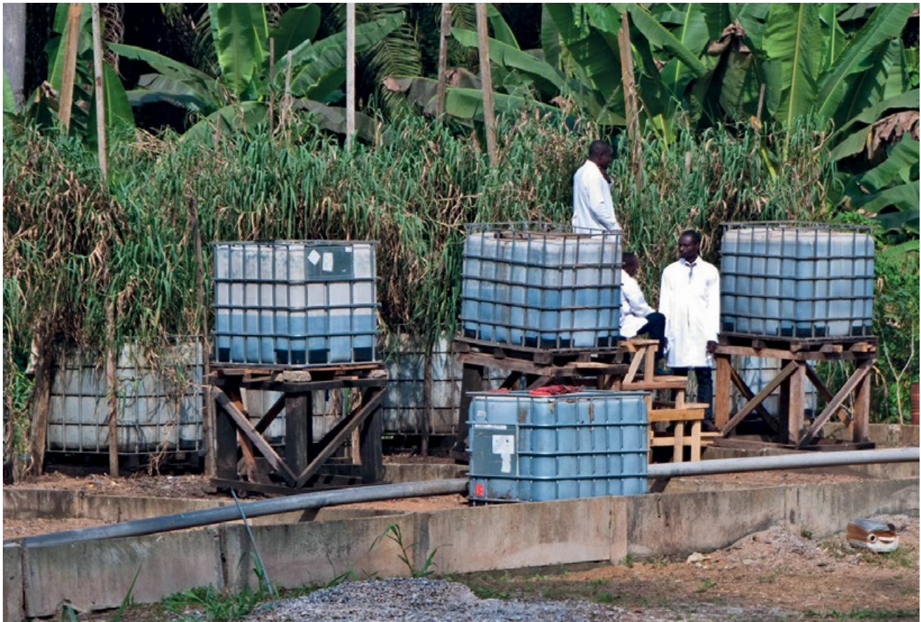
Figura 8.1 Lechos de secado con plantas, de escala piloto, para el tratamiento de lodos fecales en la Universidad Yaoundé I (foto: Linda Strande).
