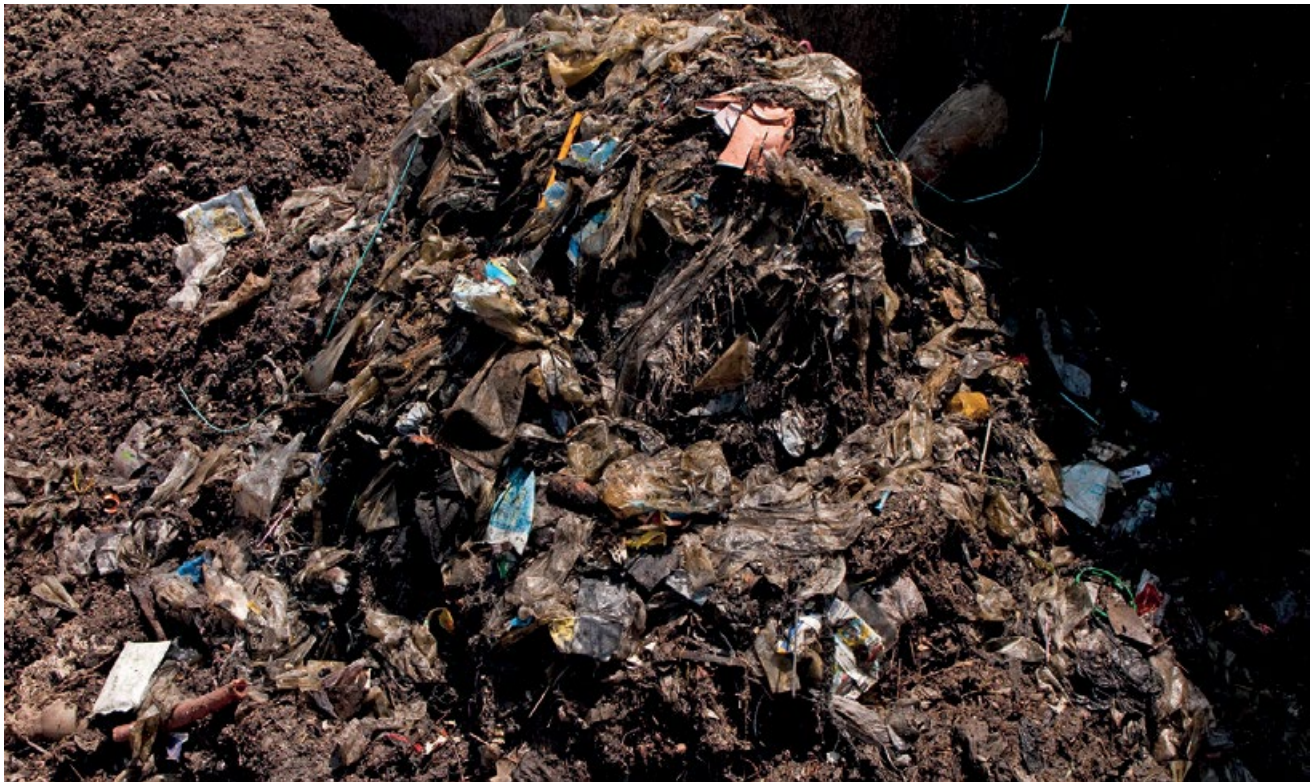
Figura 10.13 Ejemplo del material que los tamices separan de los lodos fecales afluentes en la Estación de Tratamiento de Lodos Fecales Niayes, en Dakar, Senegal (foto: Linda Strande).
