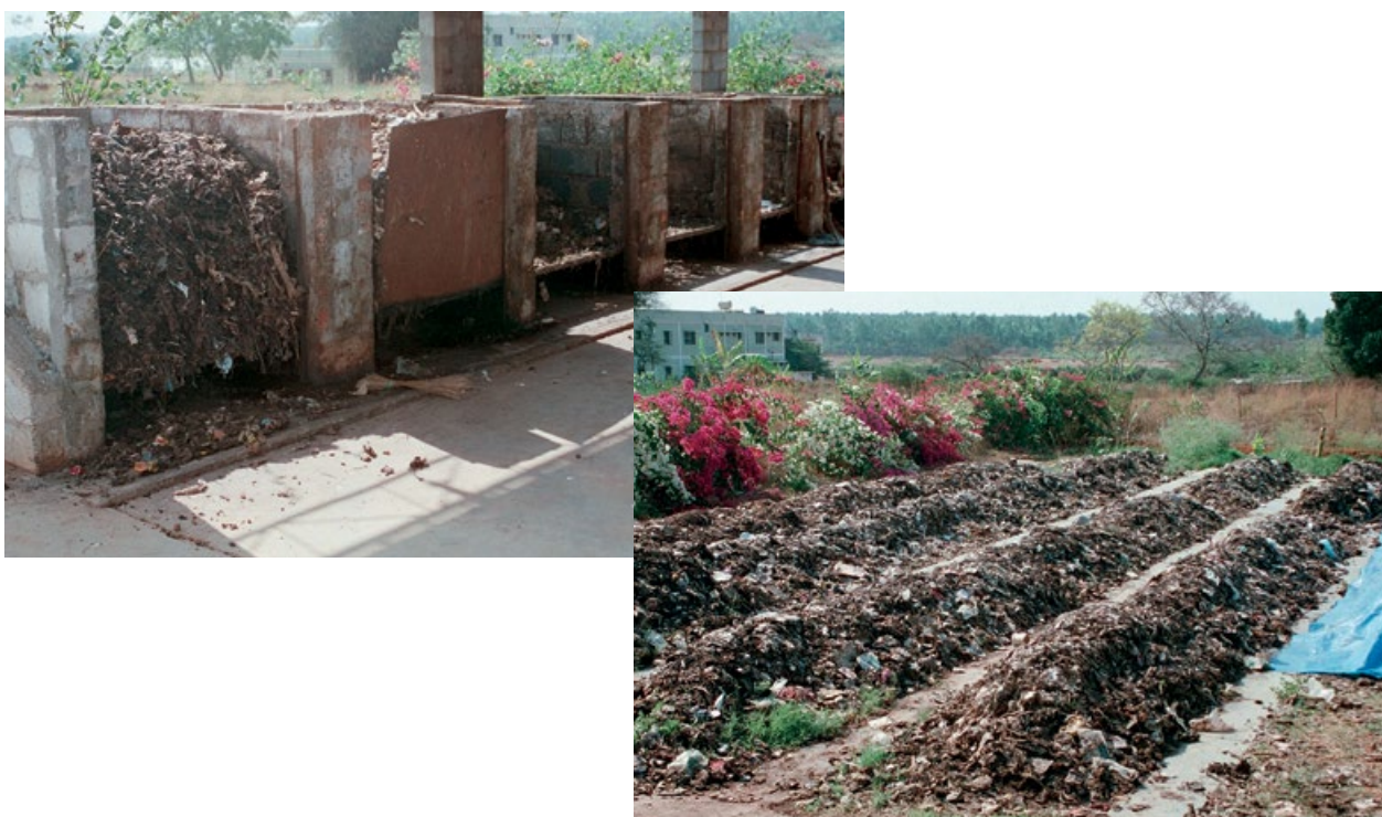
Figura 3.11 Operación de co-compostaje de lodos fecales y desechos orgánicos municipales a escala piloto en la ciudad de Bangalore, India (foto: Chris Zurbrügg).
