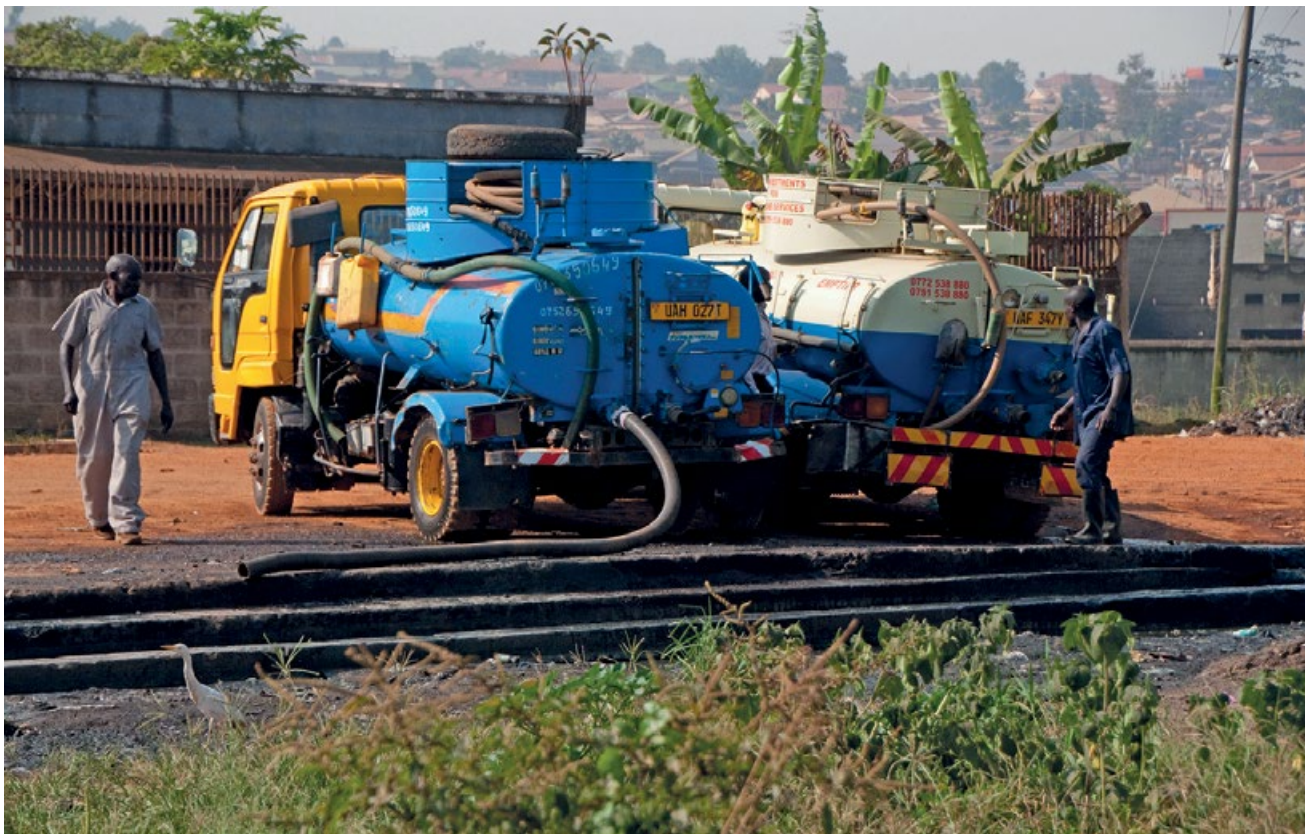
Figura 12.6 Camiones privados de recolección y transporte descargan lodos fecales en una estación municipal de tratamiento en Kampala, Uganda (foto: Linda Strande).
