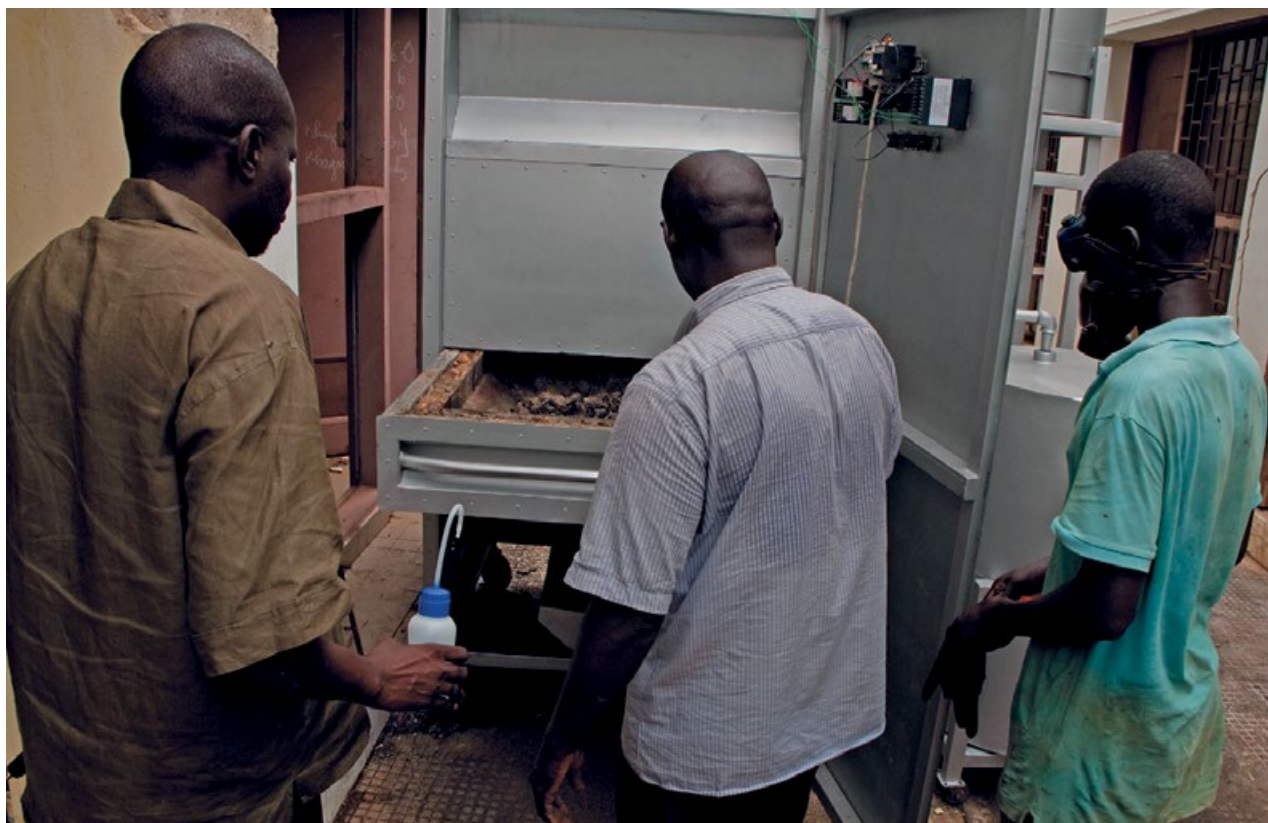
Figura 10.11 Un horno a escala piloto para quemar lodos fecales y calentar un aceite para fines industriales. Es un proyecto de FaME (Faecal Management Enterprises) y la Universidad Politécnica Thies en Senegal (foto: Linda Strande).
