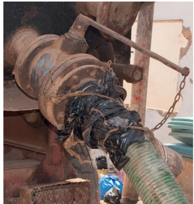
Figura 4.13 Ejemplo de una manguera mantenida indebidamente, amarrada con fundas plásticas y cuerdas (foto: David M. Robbins).
