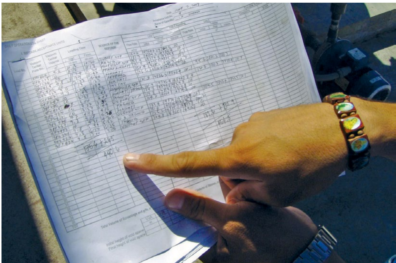
Figura 11.5 Informes de recepción permiten el seguimiento al número total de cargas entregadas, la hora, la fecha y el nombre del chofer. Estos registros son importantes para el mantenimiento en todas las estaciones de tratamiento de lodos fecales (foto: David Robbins).
