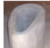
Cuvette en ciment fabriquée à l'aide d'un moule 27
