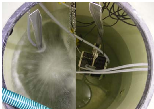
Abbildung 4 Membranbioreaktor (wasserbefüllt) mit zwei Membranmodulen (links belüftet und rechts unbelüftet) zur Filtration des gereinigten Abwassers
