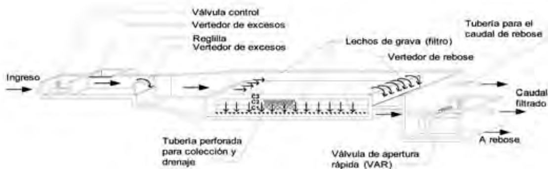
Fig. 2 Esquema del Filtro Grueso Dinámico (FGDi)
