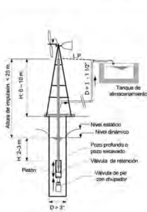
Fig. 1 Corte de aerobomba directa
