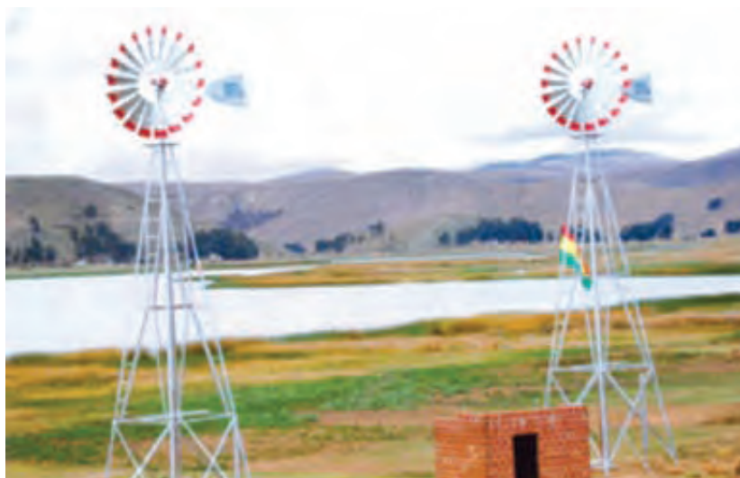
Foto 1.2 Aerobombas en paralelo Localidad: Escoma – La Paz
