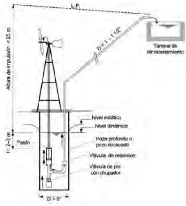
Fig. 2 Corte aerobomba indirecta
