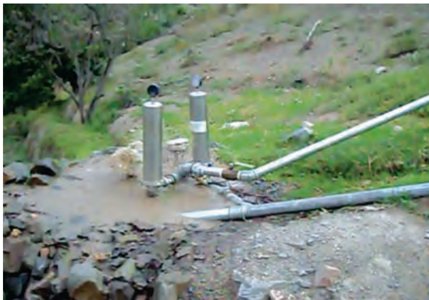
Foto 1.2 Bomba de Ariete, localidad de Tacachia, Municipio Palca - La Paz Gentileza: EWB-MST / E.I.A.
