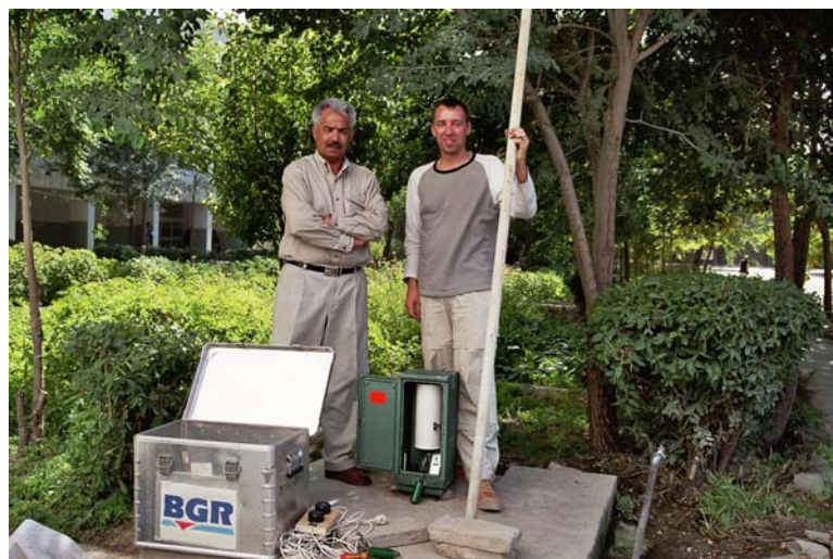
Figure 2 : Installation d'un limnigraphe sur un forage pour la mesure en continu des variations piézométriques (T. Krekeler)
