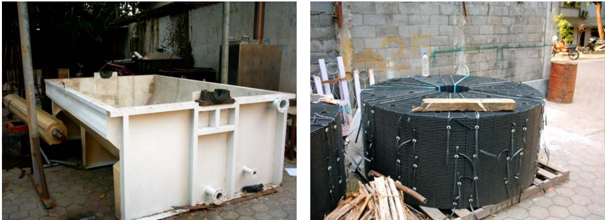
Bild 17: Scheibentauchkörperanlage vor dem Bau: Becken (links), Plastikscheiben (rechts) (PUSTEKLIM, 2004)
