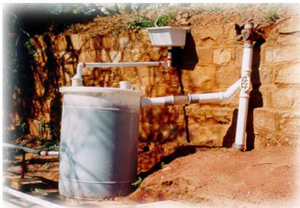
Bild 13: Versuchsanlage für Hausklärbecken mit automatischer Spülung.
