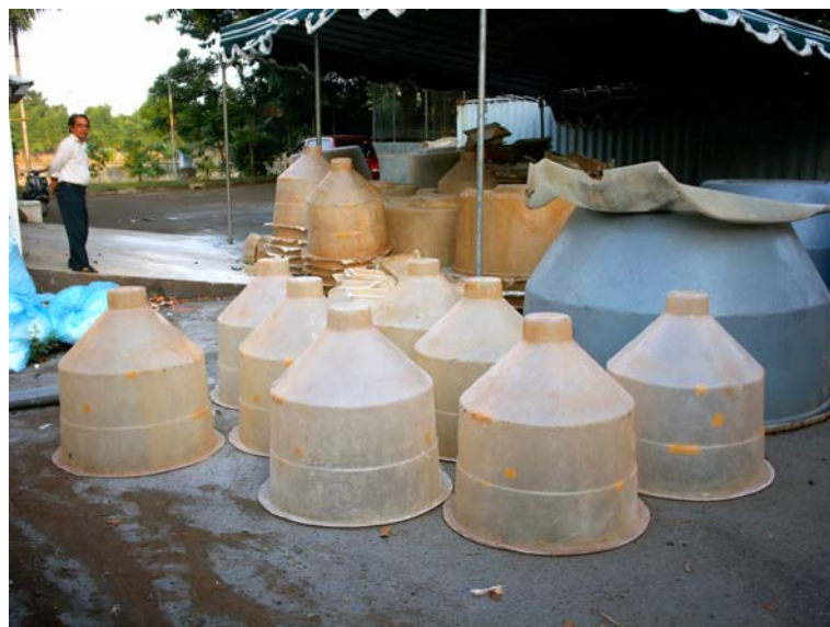
Bild 14: Nachbauten von malaysischen Prototypen für Einzelkläranlagen (PD PAL JAYA)
