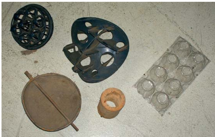
Bild 16: Filtermaterialien und Kontaktmedien für den Einbau in Filteranlagen
