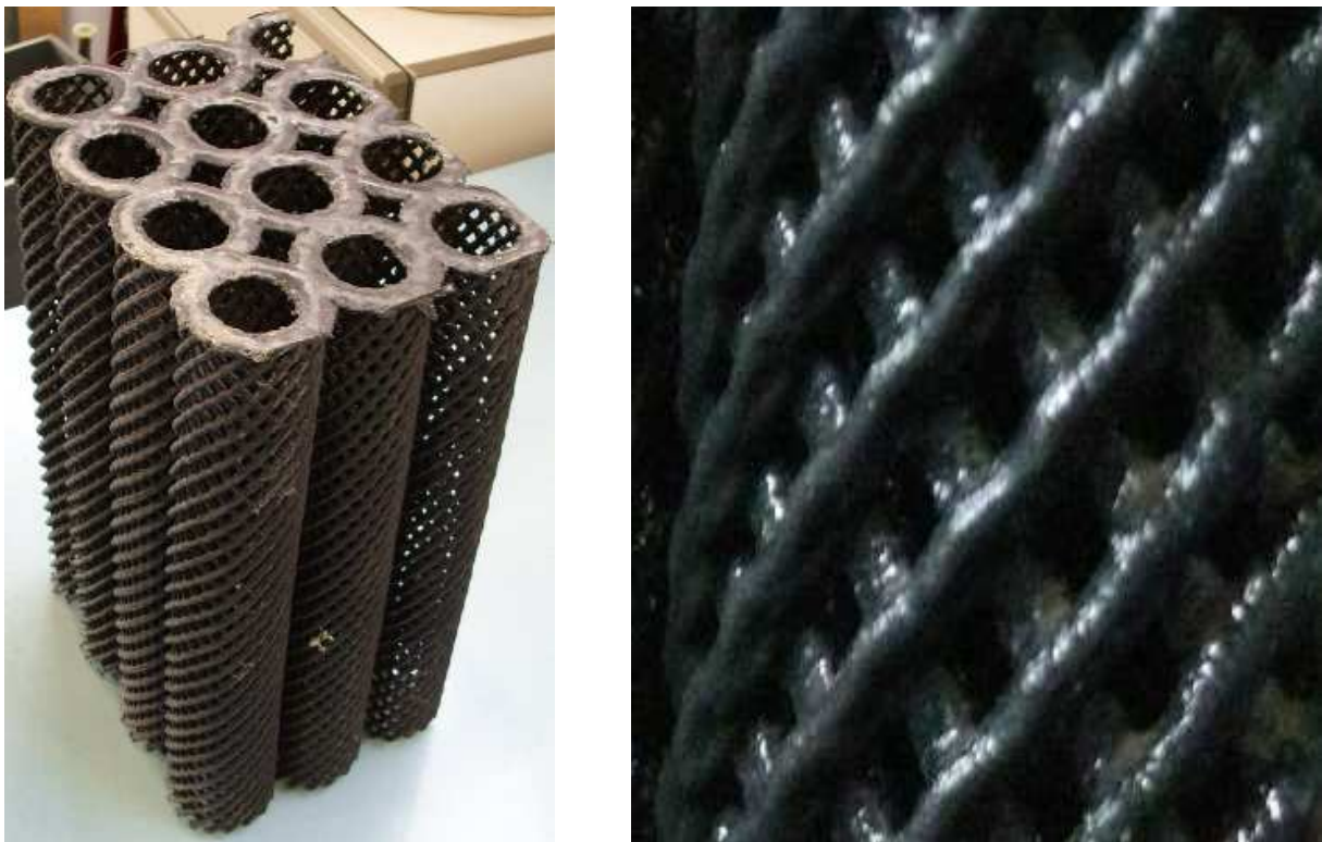
Abbildung 5.2.5: a) links: PE Röhren zu Block verschweißt; b) rechts: Detailaufnahme spiralförmig gewundene Streben (innen und außen)
