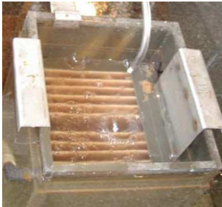
Abbildung 5.3: Getauchter Festbettreaktor (Draufsicht)
