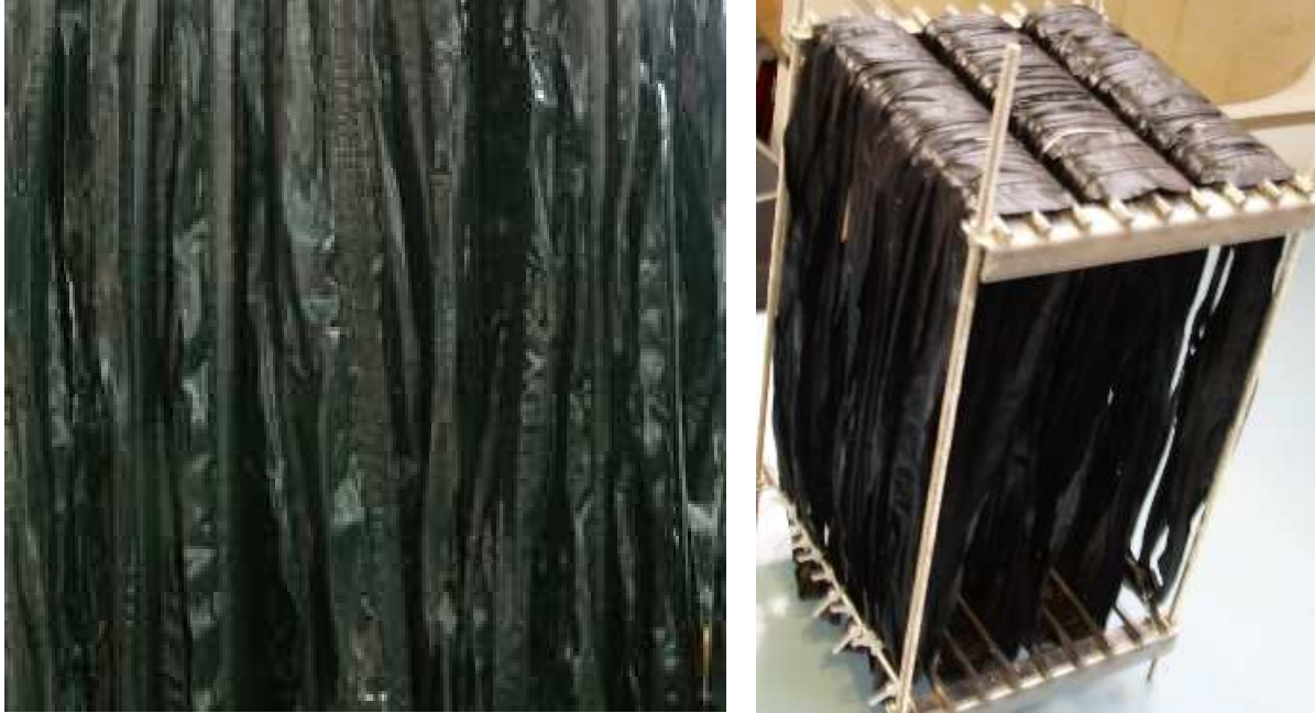
Abbildung 5.2.4: a) links: PE Streifen: Anordnung hängend dicht nebeneinander; b) rechts: Streifen um Querstreben im Metallgestell gewickelt (Versuchsaufbau)
