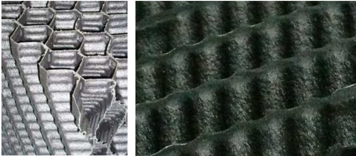
Abbildung 5.2.2: PP Folien: a) links: geklebte Folien mit eingearbeiteten Riffeln; b) rechts: Riffelung als Detailaufnahme
