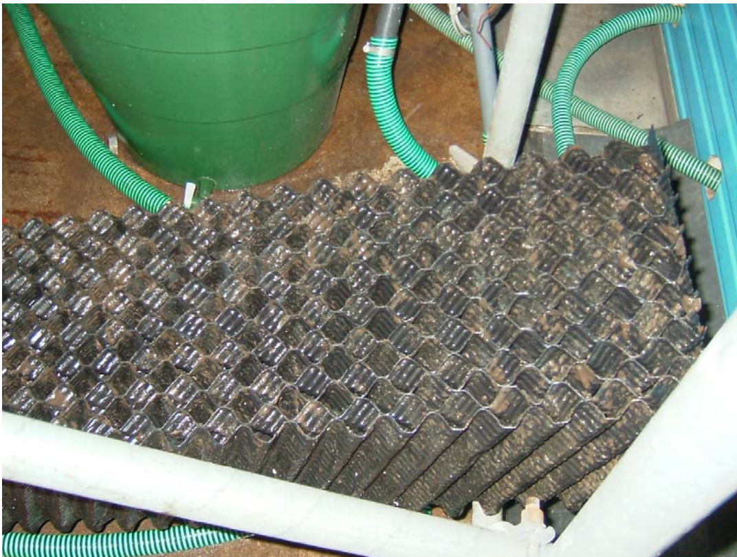
Abbildung 12b: Ansicht der beiden im Versuchstropfkörper der Universität Stuttgart eingesetzten Füllmaterialien.
