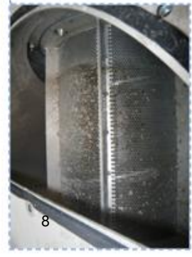
2 - Siebkorb mit Schnecke zur Feststoffabscheidung (Lochdurchmesser: 3 mm)
