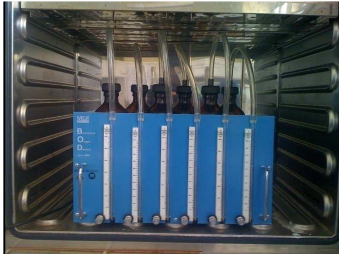
Photo N°7: introduire l'échantillon dans l'enceinte à 20°C
