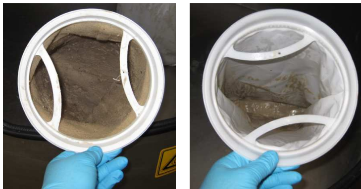
Abbildung 44: Links: Filtersack aus Polypropylen mit MAP belegt; Rechts: Filtersack aus Polyamid mit MAP belegt.
