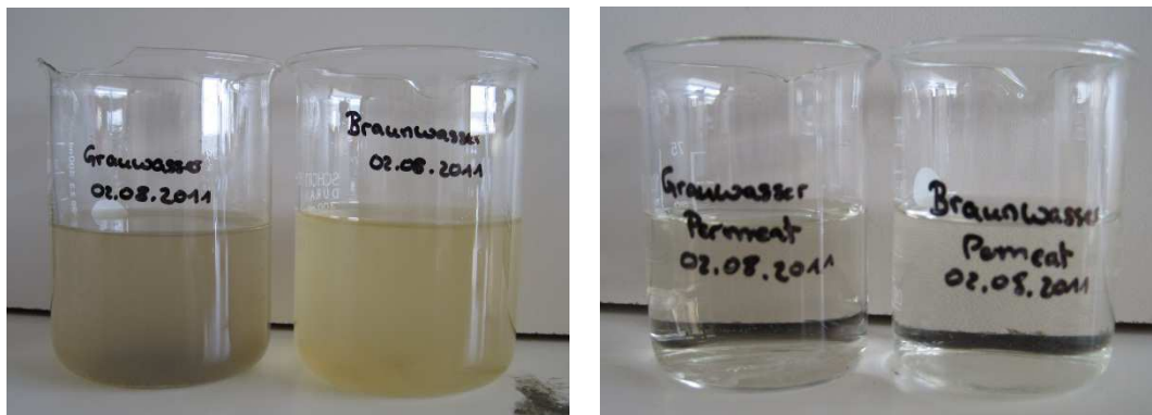
Abbildung 47: Links: Zulauf des Grauwasser-MBR (links) und des Braunwasser-MBR (rechts); Rechts: Permeat der MBR: Grauwasser (links), Braunwasser (rechts).
