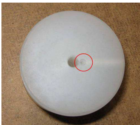
Abbildung 7: Die kegelförmig ausgebildete Aufnahmefassung für den Bowdenzug im Ventilkörper (Ansicht von unten, Aufnahmefassung rot markiert).
