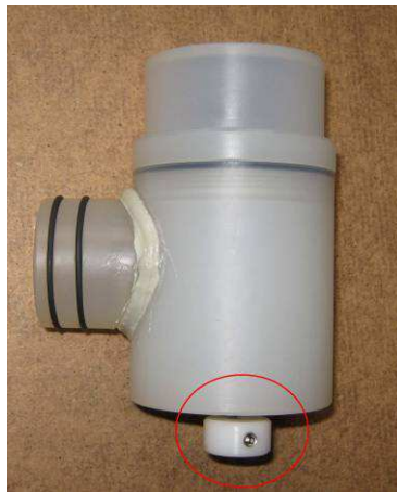
Abbildung 8: Urinablauftrichter mit der geänderten Passsicherung (Ansicht von der Seite, rot markiert) für den Bowdenzug.
