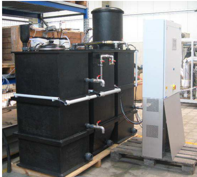
Abbildung 29: Testbetrieb der Grauwasseranlage im Werk der HUBER SE.
