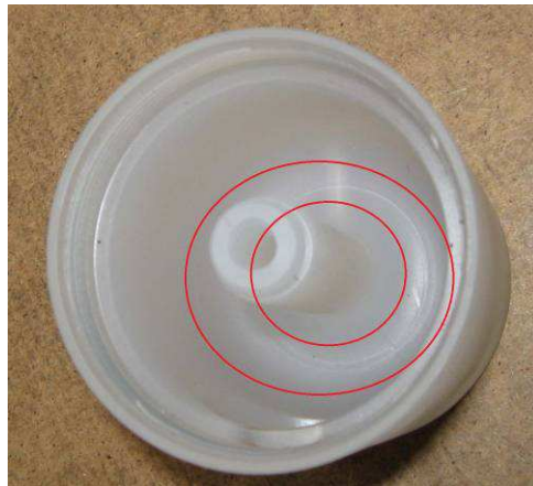
Abbildung 6: Blick auf die abgerundeten Innenkanten im Ventilkörper innen.
