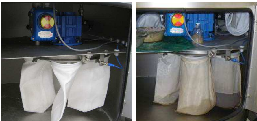
Abbildung 19: Links: Neue Filtersäcke (Nadelfilz) eingehängt in Filtersackrevolver; Rechts: Befüllte Filtersäcke (Nylon) eingehängt in Filtersackrevolver.
