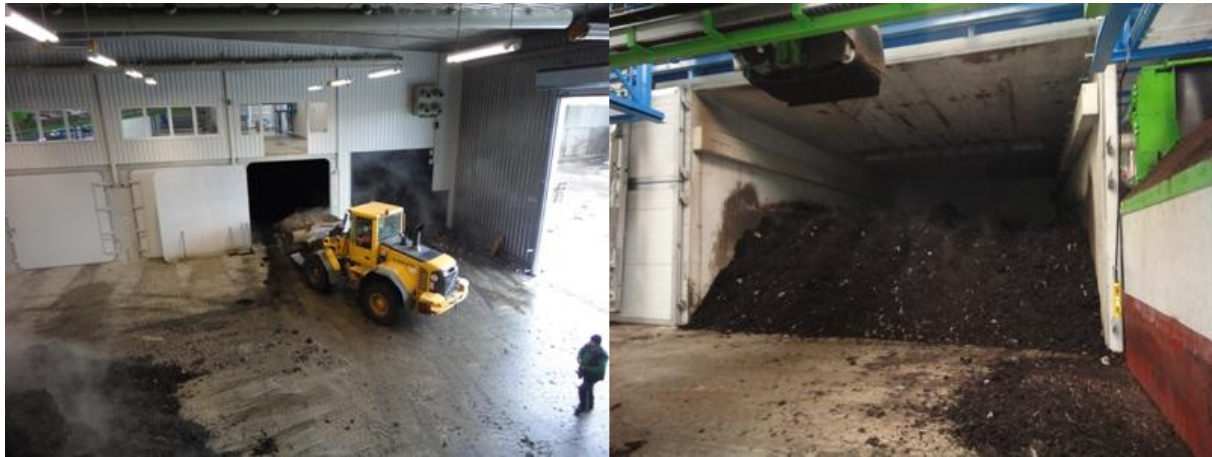
Abbildung 4-5: Beladung eines Tunnels mit Frontlader (links) und einer automatischen Beschickung (rechts) im Kompostwerk Warngau [46]
