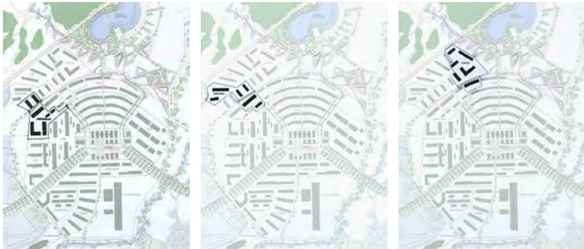
Situationsplan mit den mit neuartigen Sanitärssystemen ausgestatteten Siedlungsteilen. Von links nach rechts: "Lebensräume" mit 40 WE, "Eigenheim" mit 24 WE, "GIWOG" mit 24 WE. Quelle: Linz_Leben (2012)
