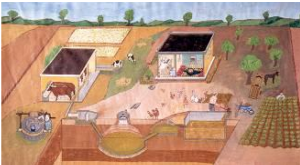
Figure 12 : Les différents éléments d'une installation à biogaz.
