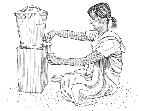
Figure 5.7. Robinet installé sur un seau
