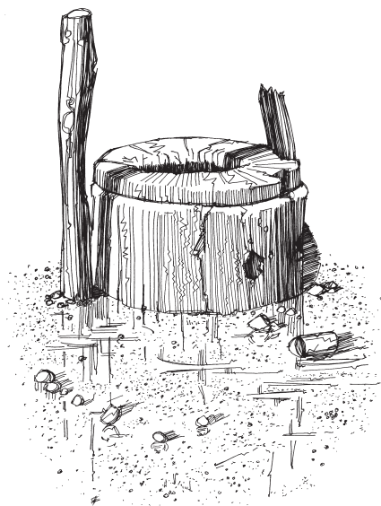
Figure 15.3. Un puits endommagé, avec des fissures dans les murs
