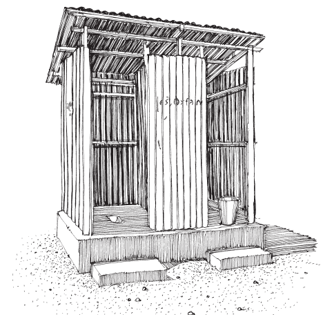
Figure 9.3. Latrines à chasse d'eau manuelle
