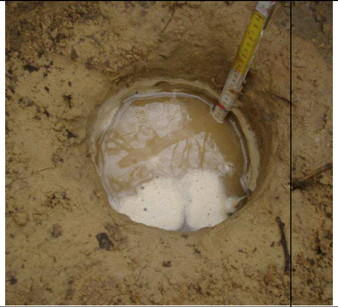
Prise de mesure de la vitesse d'infiltration par la méthode à niveau variable. (Photo Epuvaleur asbl)
