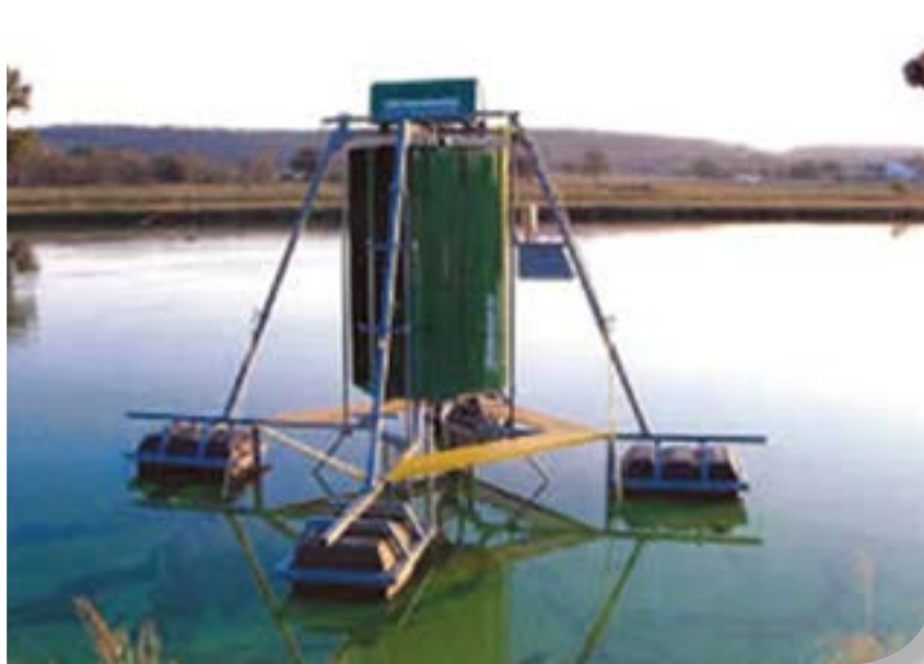
Foto 12: Sistema de aireación superficial
